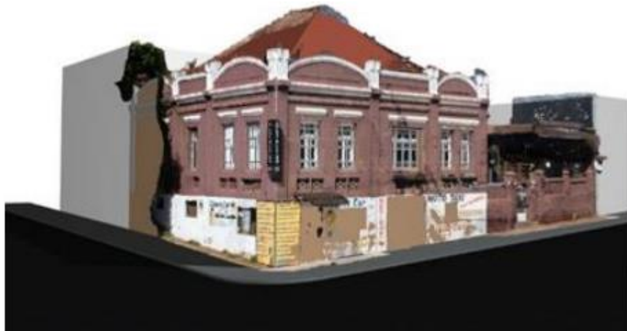
Figura 4.17: Sobreposição dos modelos de nuvem de pontos e BIM
