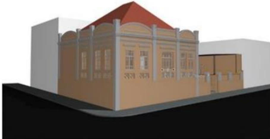
Figura 4.16: Modelo tridimensional compatibilizado por nuvem de pontos
