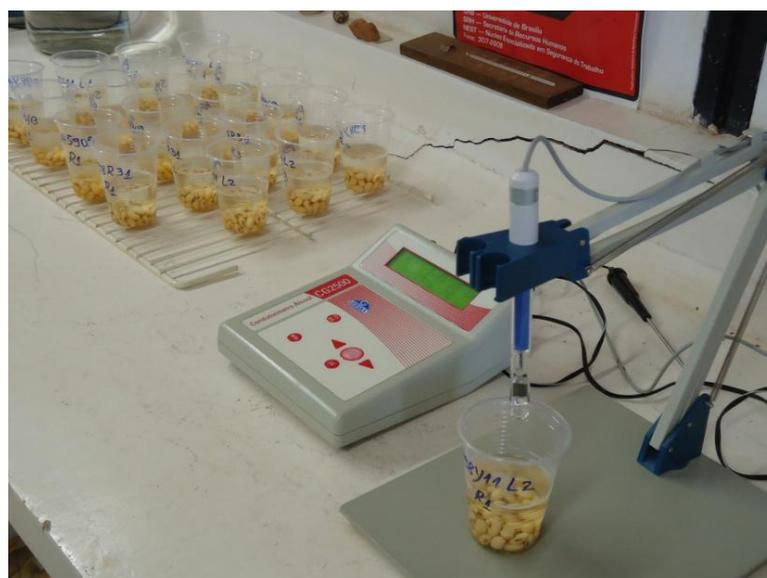
Figura 3A – Teste de Condutividade Elétrica (CE).
