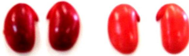
**Figura 7A** - Teste de Tetrazólio: semente com dano mecânico/ tecido deteriorado e semente perfeita, respectivamente.
