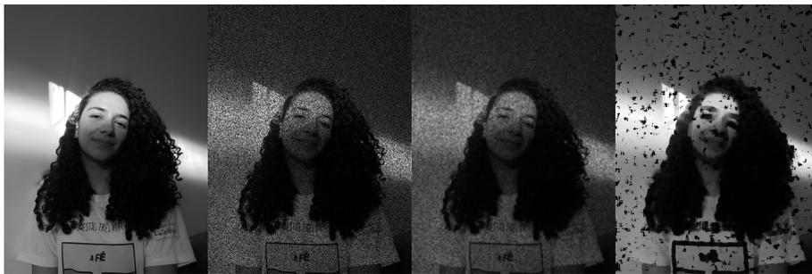
Figura 11 – Da esquerda para a direita. A primeira imagem é a original, capturada pela câmera e sem defeitos. A segunda, adicionando ruído sal(ruído branco) e pimenta (ruído preto). A terceira, aplicando blur gaussiano com máscara de 15x15 em duas iterações. A quarta, aplicando filtro de mediana com máscara 15x15.
