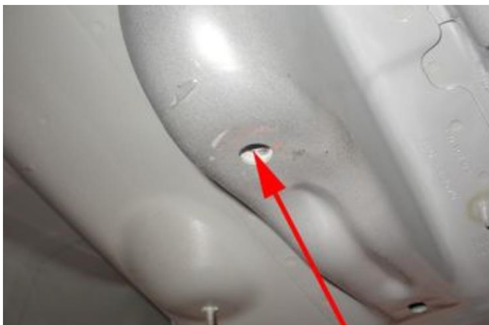
Figura A.9. Pontos de medição 15 e 16, simétricos, referentes aos lados esquerdo e direito do veículo, respectivamente.
