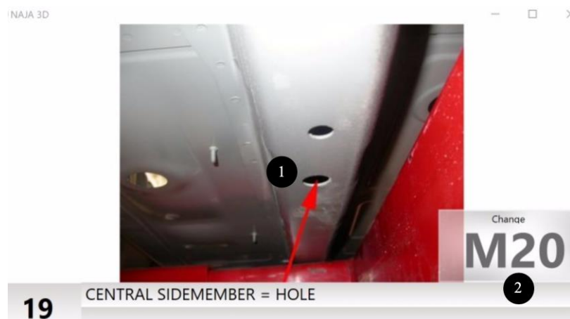
Figura 57. Tela do ambiente de medição indicando a localização do ponto (1) e o adaptador correto (2) para medição de um dos pontos escolhidos como referência.
