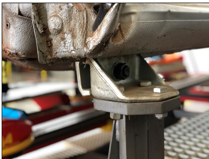
Figura 48. Detalhe do chassi monobloco fixado ao elevador pneumático Rhone por meio de garras metálicas.
