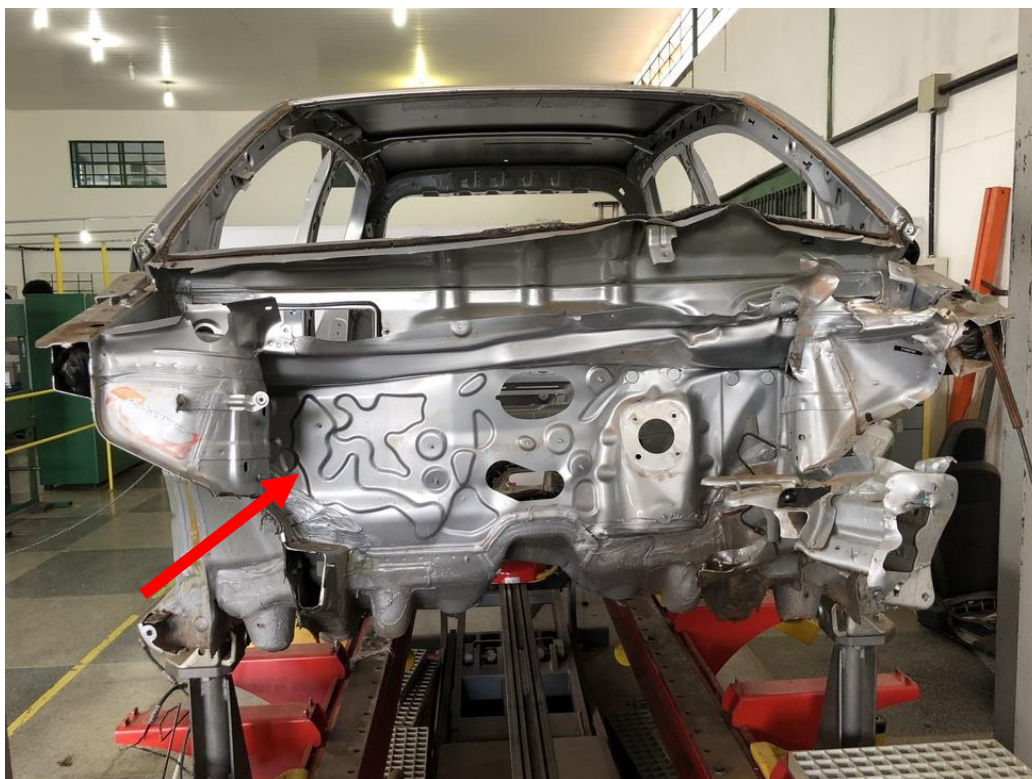
Figura 71. Chassi monobloco do Volkswagen Up! , após retirada da longarina dianteira menos afetada.
