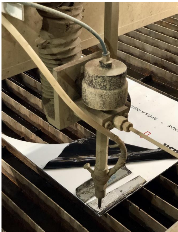
Figura 73. Processo de corte à Jato d'água dos corpos de prova do Volkswagen Up!.
