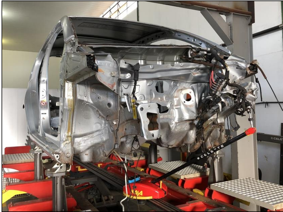
Figura 64. Vista em perspectiva do processo de medição da longarina dianteira direita. Equipamento NAJA 3D com o extensor acoplado e o adaptador engastado em um dos pontos de medição.
