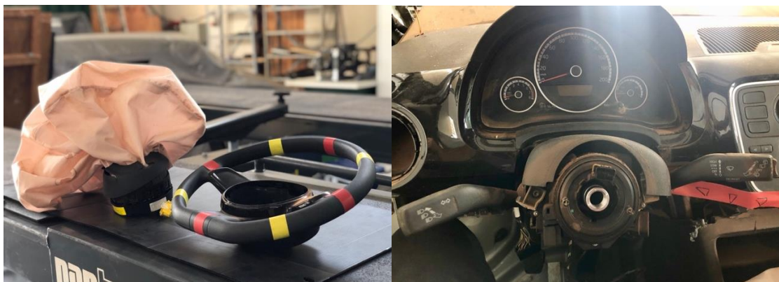
Figura 39. Figuras (a) e (b). Airbag do motorista deflagrado após o impacto e volante do motorista removido.
