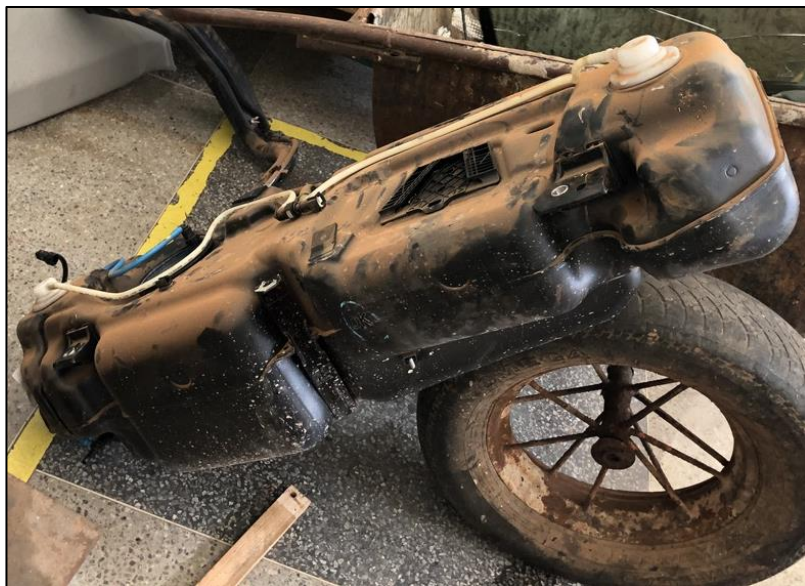
Figura 35. Tanque de combustível retirado do veículo, após o processo de drenagem.
