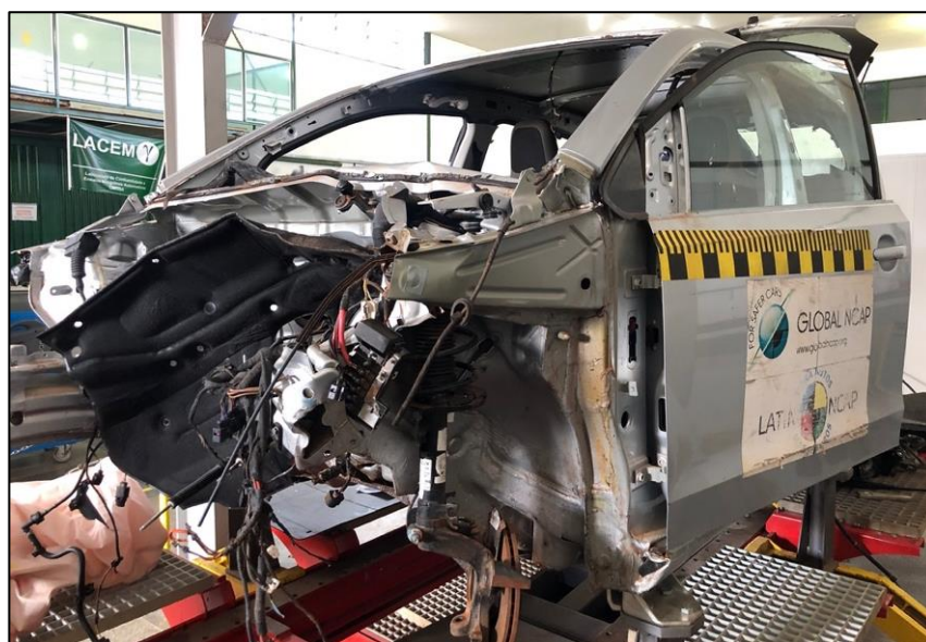
Figura 42. Veículo em avançado estado de desmonte, após remoção do para-brisa. Destaque para a porta do motorista, que abre e fecha normalmente, mesmo após impacto contra a barreira deformável.
