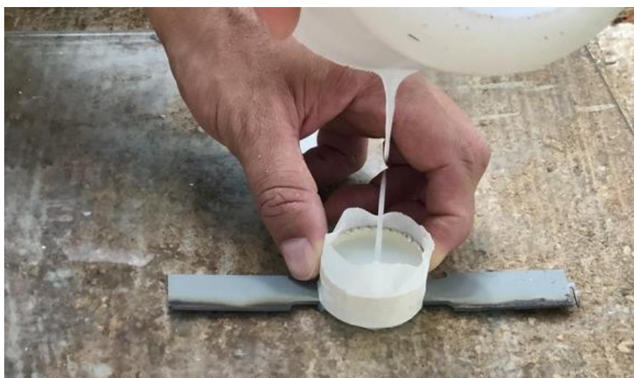
Figura 78. Embutimento do corpo de prova utilizando-se PVC e material polimerizante.
