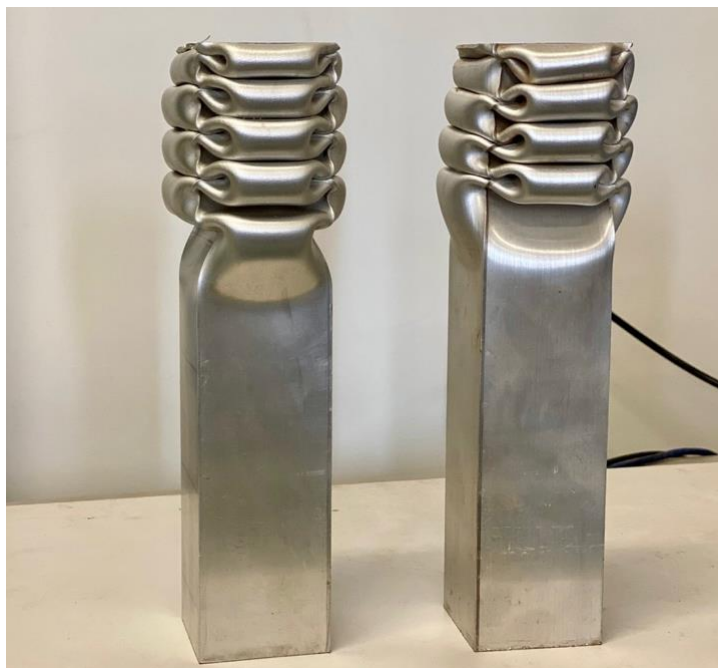
Figura 85. Exemplo de flambagem progressiva.
