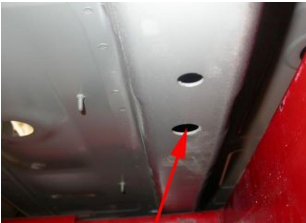
Figura A.10. Pontos de medição 19 e 20, simétricos, referentes aos lados esquerdo e direito do veículo, respectivamente.
