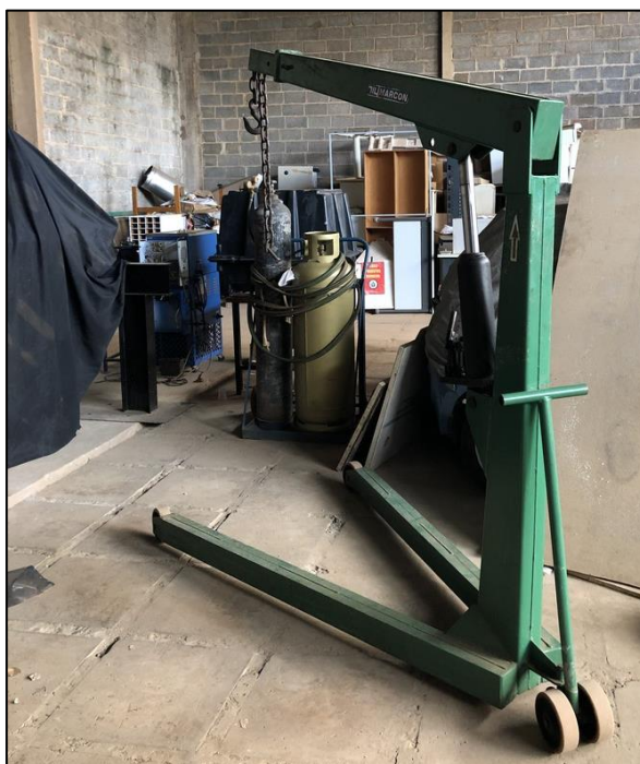
Figura 31. Guincho hidráulico Marcon, utilizado para apoiar e retirar o conjunto motriz.
