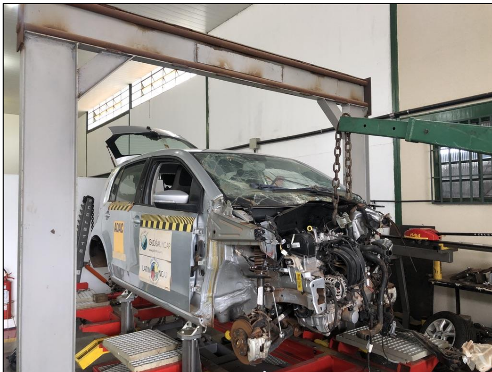
Figura 30. Veículo suspenso no elevador pneumático, após o desmonte dos para-lamas dianteiros e do conjunto de rodas/pneus.
