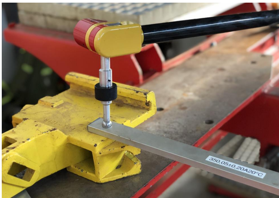
Figura 69. Medição da régua padronizada. Etiqueta referente à incerteza deste instrumento visível.
