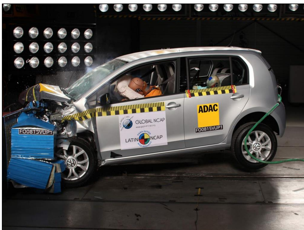
Figura 28. Volkswagen Up! em teste de impacto frontal conduzido pelo instituto Latin NCAP, no momento da colisão contra a barreira deformável.
