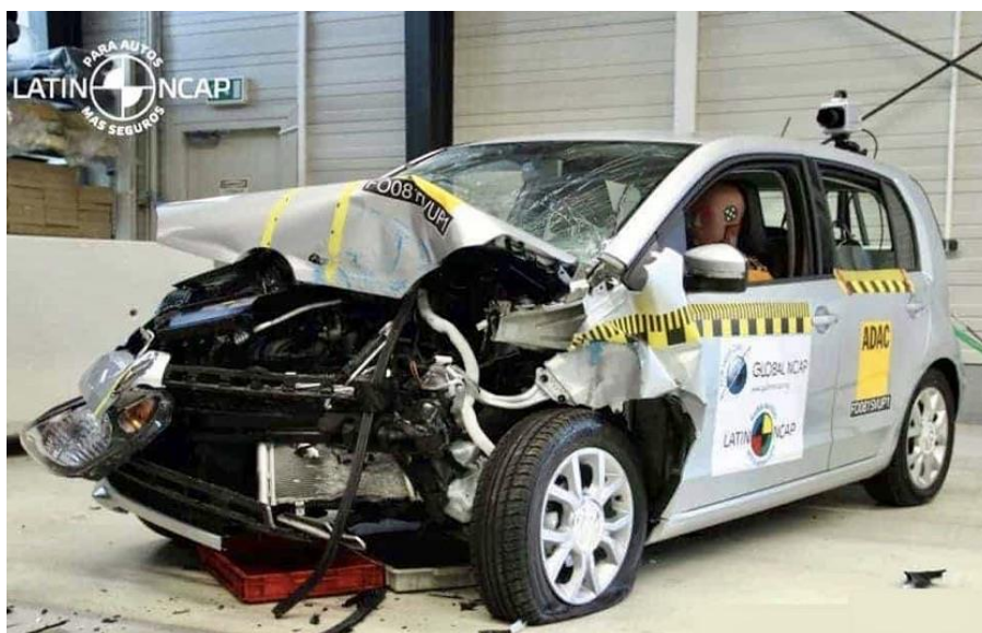
Figura 23. Volkswagen Up! após teste de colisão frontal realizado em laboratório, modelo exato utilizado por este trabalho.
