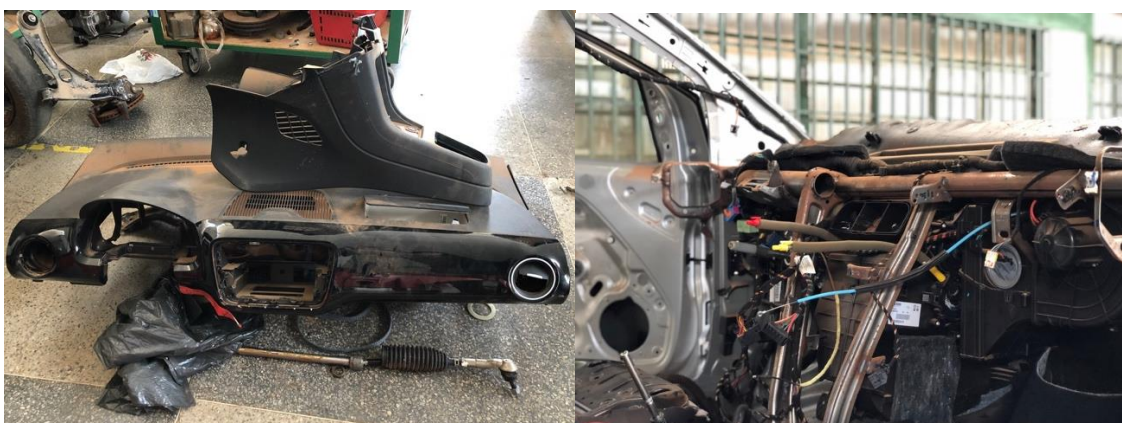
Figura 41. Figuras (a) e (b). Painel e console central removido, expondo a estrutura metálica e partes do chicote elétrico.
