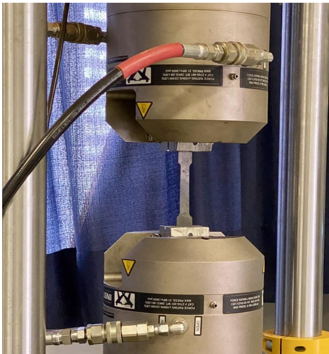
Figura 13. Corpo de prova de aço 1020 posicionado na Instron 8801, imediatamente antes da realização do ensaio.
