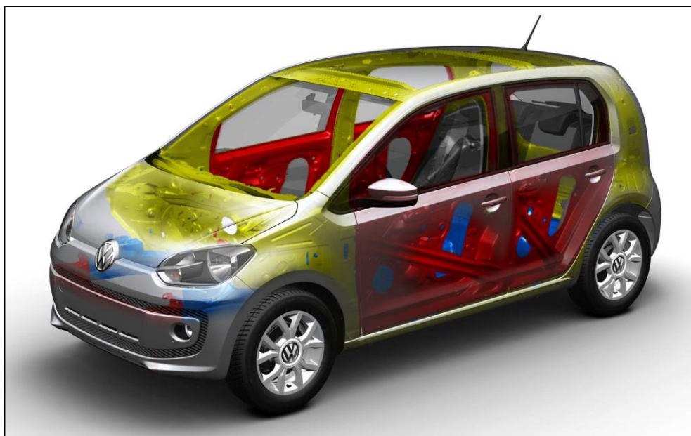
Figura 21. Representação do Volkswagen Up! e dos diversos tipos de aço que o compõe.
