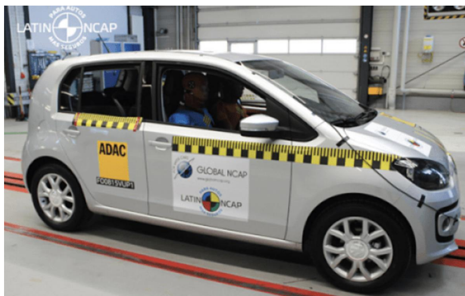
Figura 25. Volkswagen Up! durante preparação que antecede a realização do ensaio de colisão pelo Latin NCAP.
