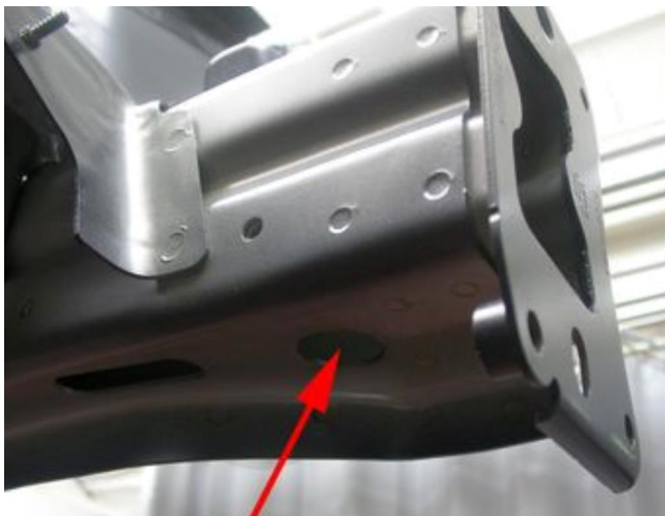
Figura A.6. Pontos de medição 7 e 8, simétricos, referentes aos lados esquerdo e direito do veículo, respectivamente.
