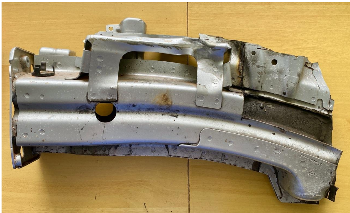
Figura 72. Longarina dianteira direita, menos afetada pela colisão frontal, retirada do veículo.
