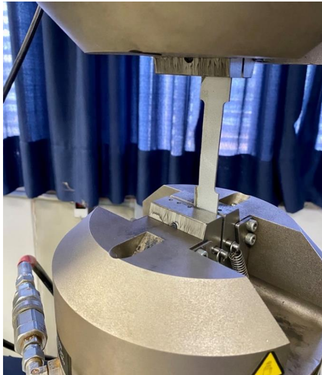
Figura 74. Corpo de prova do Volkswagen Up!, precedendo o ensaio quase estático.
