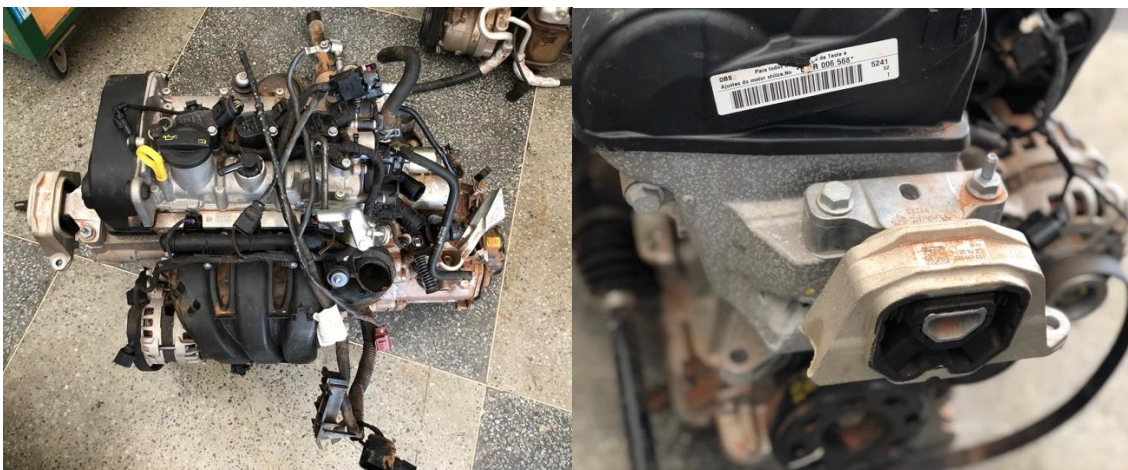
Figura 33. Figuras (a) e (b). Motor tri cilíndrico do Volkswagen Up! retirado do exemplar cedido pela Latin NCAP e detalhe do coxim fraturado devido ao impacto sofrido.
