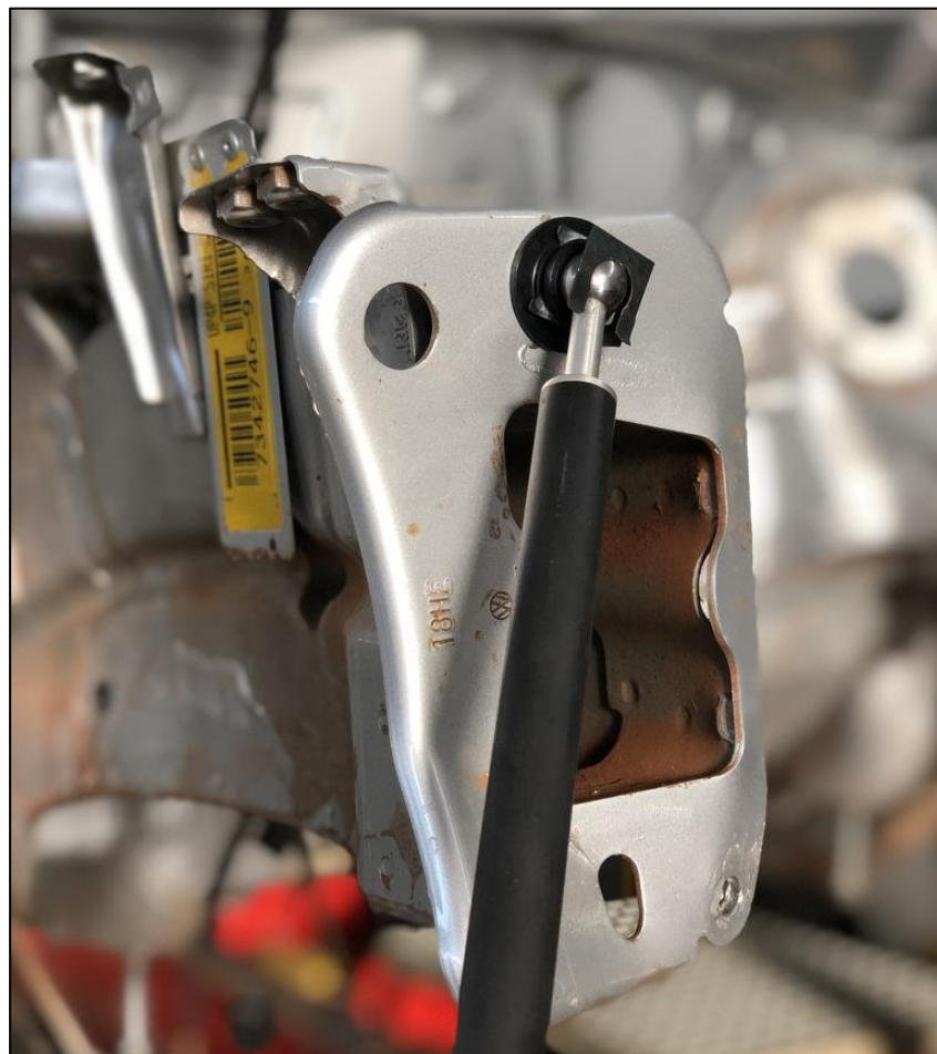
Figura 63. Processo de aferição da longarina dianteira esquerda, menos afetada.
