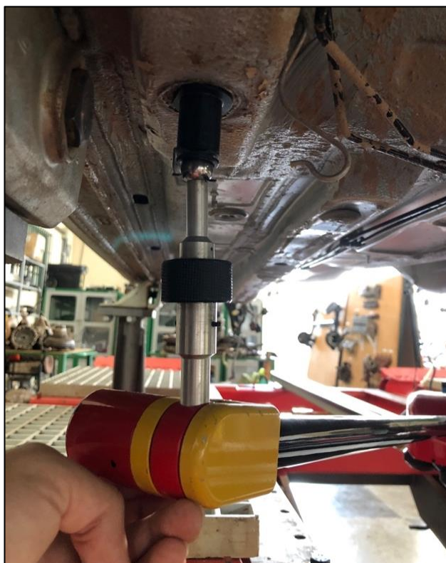
Figura 59. Momento exato da medição de um dos pontos escolhidos como referência. Após encaixe do adaptador correto ao ponto indicado no chassi, pressiona-se o botão localizado no braço do equipamento NAJA 3D e uma coordenada tridimensional é gerada.
