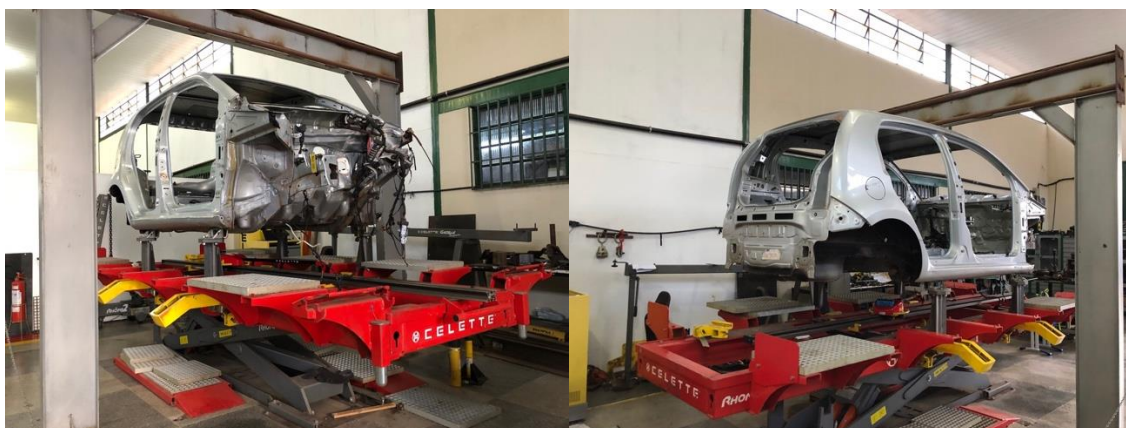
Figura 49. Figuras (a) e (b). Chassi monobloco exposto, após a retirada de peças. Veículo preso diretamente ao elevador pneumático, que fora erguido para facilitar as medições.
