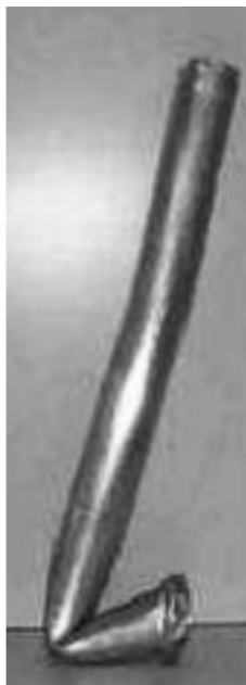
Figura 87. Exemplo de flambagem global.
