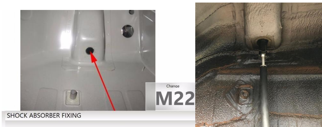
Figura 60. Figuras (a) e (b). Indicação do local e adaptador correto e posicionamento do equipamento para realização da medida.
