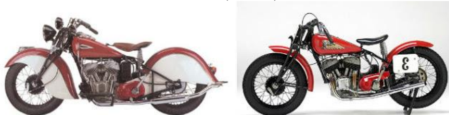
Figura 15 - Mudanças realizadas em uma motocicleta comum (esquerda) para um estilo Bobber (direita)
