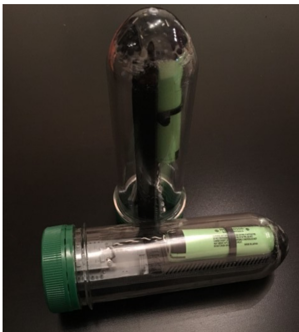
Figura 1.2 – Densímetro digital iSpindle (Disponível em https://www.ispindel.de )
