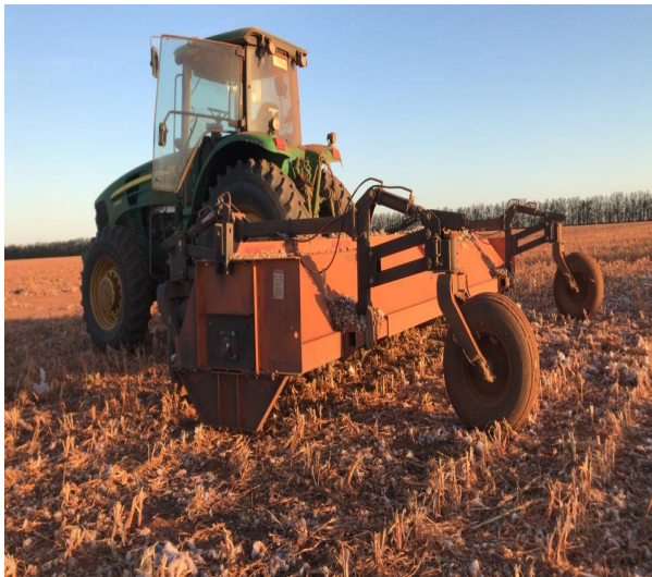
Figura 29. Trincha utilizada no processo de destruição de soqueira do algodoeiro (Fonte: LEAL,2020)
