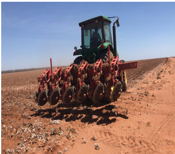
Figura 30. Chopper 550 utilizado para o arranquio das soqueiras do algodão (Fonte: LEAL,2020).
