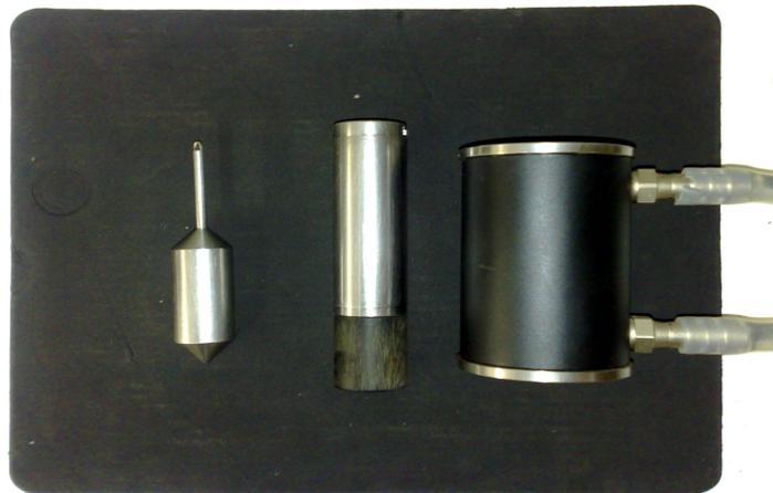
Figura 4.1: Acessórios do viscosímetro Brookfield. Da esquerda para direita: cilindro rotativo, cilindro estacionário e cavidade do sistema térmico.
