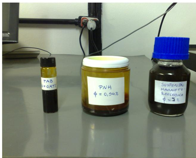
Figura 4.8: Suspensões magnéticas caracterizadas na ausência de campo magnético. Da esquerda para a direita: PAB, PNH e Suspensão magneto-reológica.
