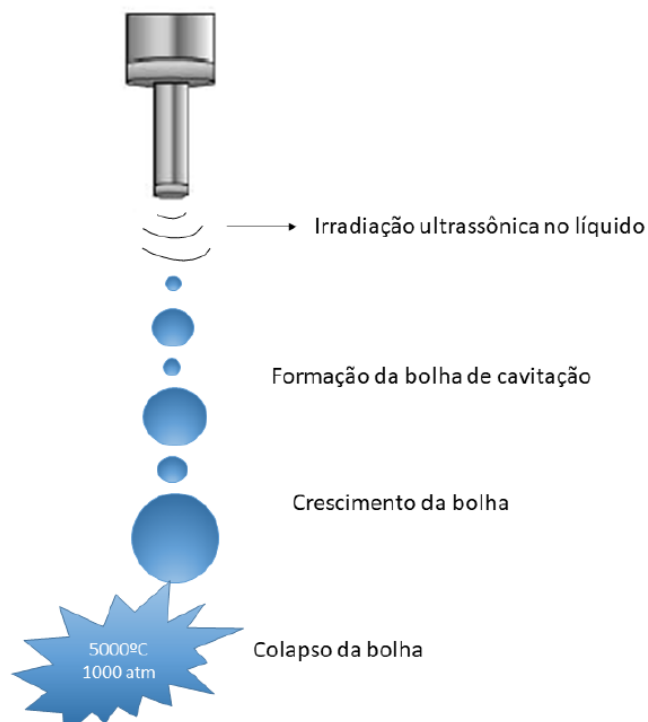
Figura 27: Esquemática do fenômeno de cavitação (RAMALHO, 2019).
