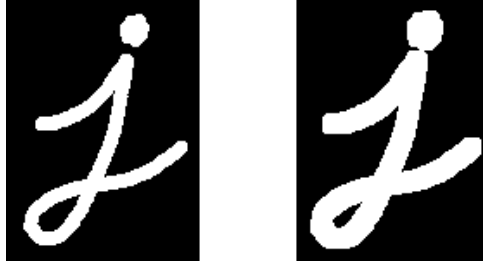
Figura 2.9: Imagem de entrada e saída da operação de dilatação (Fonte: [36]).
