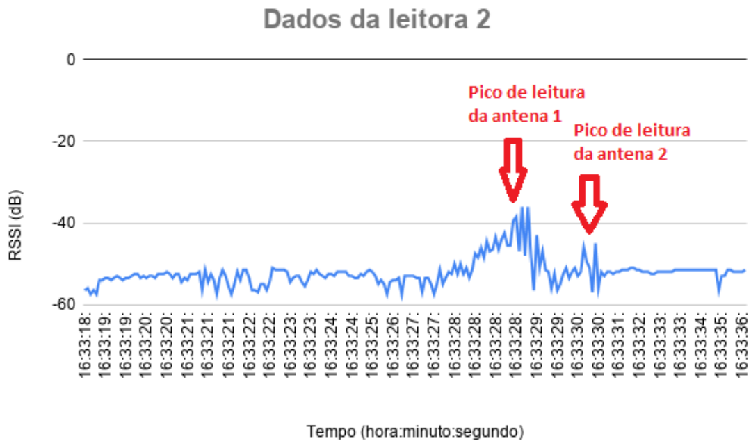
Figura 4.41: Leitura RSSI para passagem de 2 tags simultaneamente.
