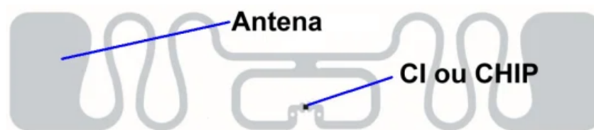
Figura 2.5: Componentes básicos de uma tag. Fonte: https://rfidmoura.wordpress.com/
