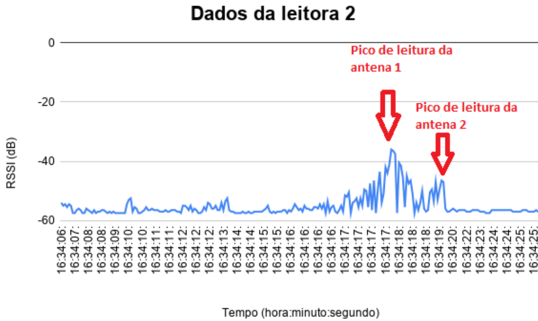
Figura 4.45: Leitura RSSI para passagem de 3 tags simultaneamente.
