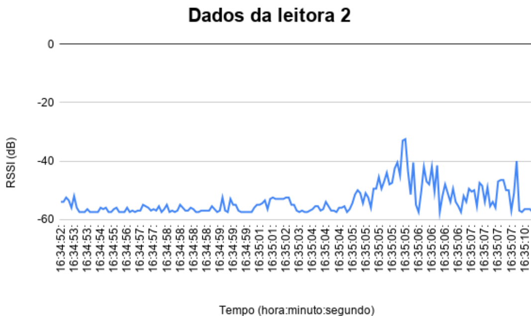
Figura 4.49: Leitura RSSI para passagem de 4 tags simultaneamente.
