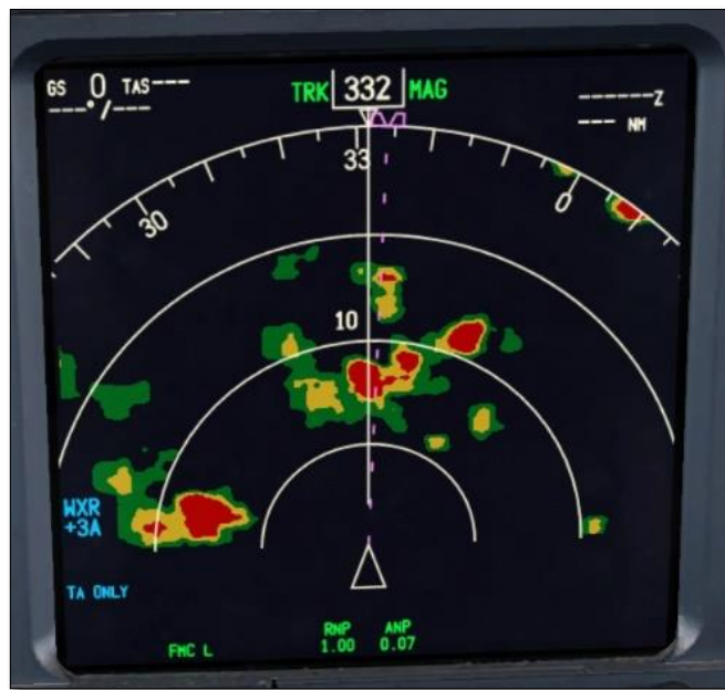
Figura 9.3 - Display do radar meteorológico na aeronave [31]
