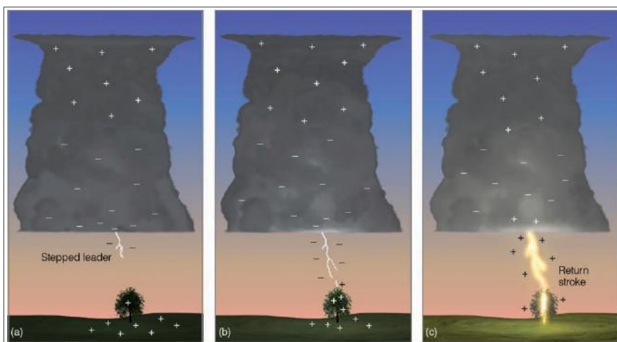
Figura 5.3 – Formação de descargas atmosféricas nuvem-solo [11]
