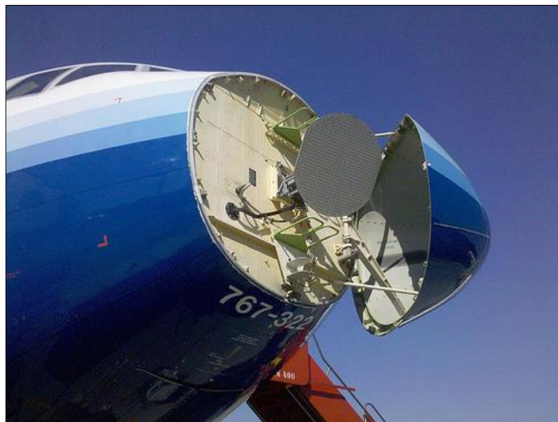
Figura 9.2 – Radar Meteorológico no nariz de um B767 [30]
