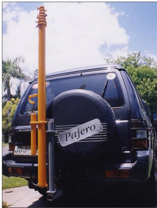
Figura 10.21 - Carro com Mastro da “Clark Masts” instalado [53]
