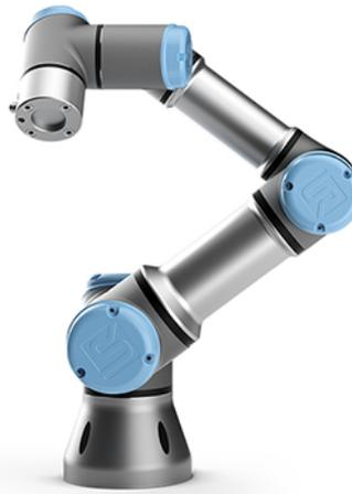
Figura 2.3: Manipulador robótico UR3 [2].
