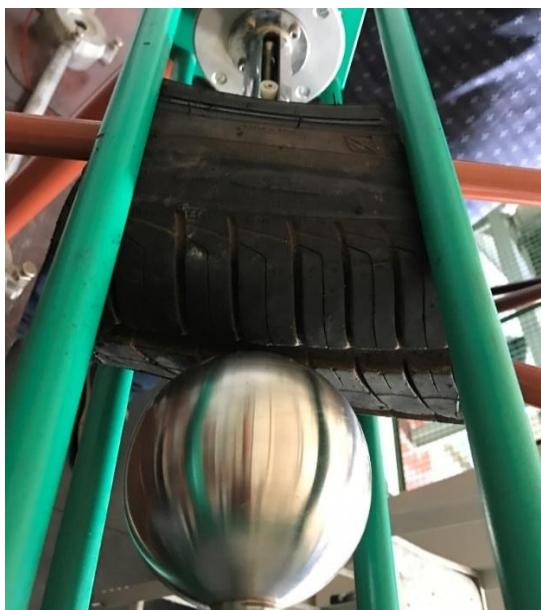
Figura 5.11 - Posição do pneu entre as duas esferas.
