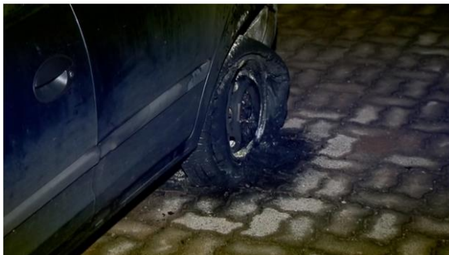
Figura 5.17- Foto do estado do pneu após o contato com o cabo energizado. [29]
