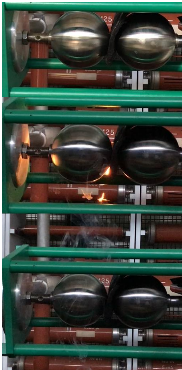
Figura 5.10 - Centelhas e fumaça do pneu durante a realização do ensaio.
