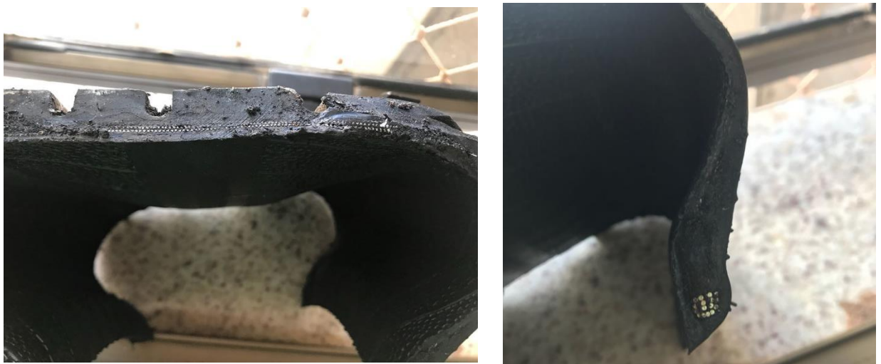
Figura 5.13- Índícios de aço dentro do pneu.
