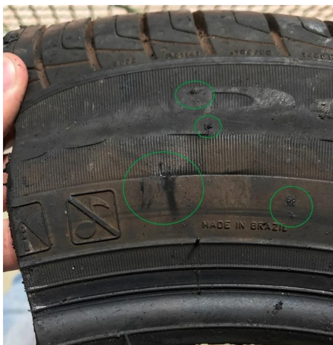
Figura 5.12 - Estado do pneu após a realização do ensaio.
