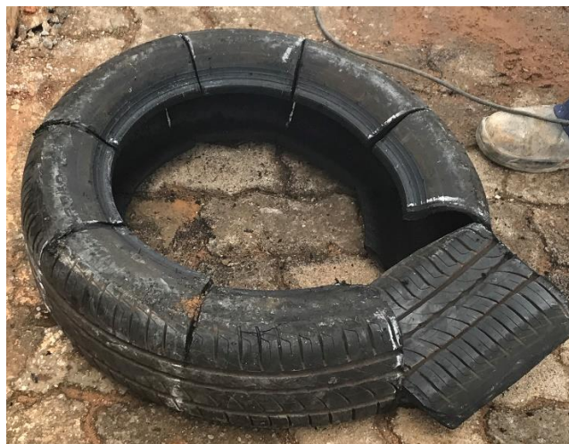
Figura 5.3- Cortes realizados no pneu.
