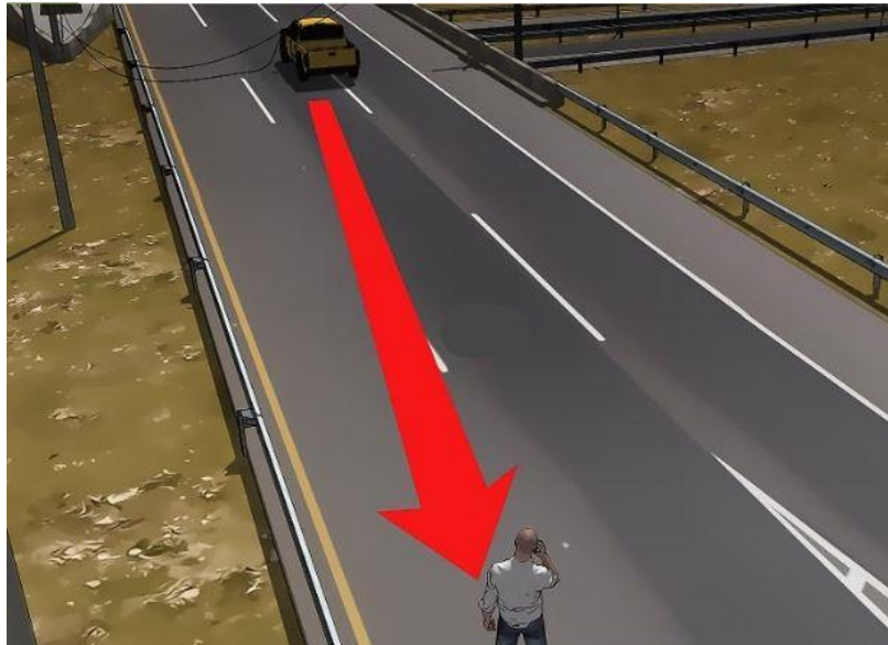
Figura 6.6- Quanto maior a distância, menor é o risco de uma tensão de passo [30]
