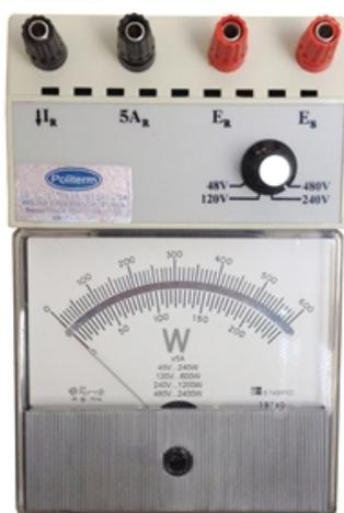
Figura 2.3: Modelo de Wattímetro analógico(POLITERM, 2016)
