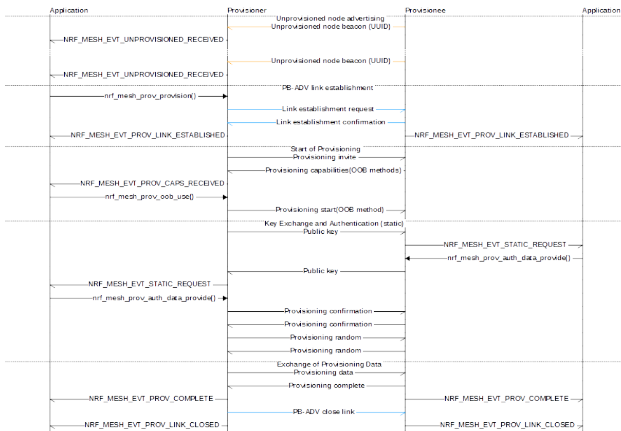
Figura 3.7: Fluxo de mensagens do mecanismo de provisionamento na solução Nordic (Nordic Semiconductor, 2018).
