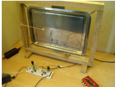
Figura 1.4: Pequeno protótipo de um reverb de placas.
