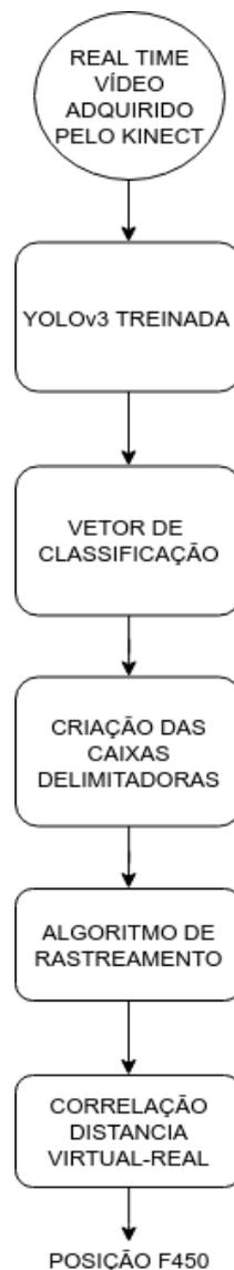
Figura 24 – Passos para realizar a integração do sistema de detecção e rastreamento do quadricóptero, em um vídeo.
