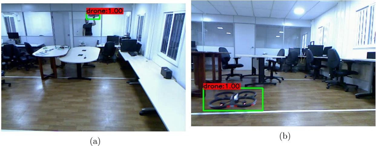
Figura 33 – Exemplo do funcionamento do algoritmo YOLOv3 para o quadricóptero Parrot Ar. Drone 2.0, treinado por meio de *Transfer Learning* para o conjunto de imagens de teste do *dataset*.
