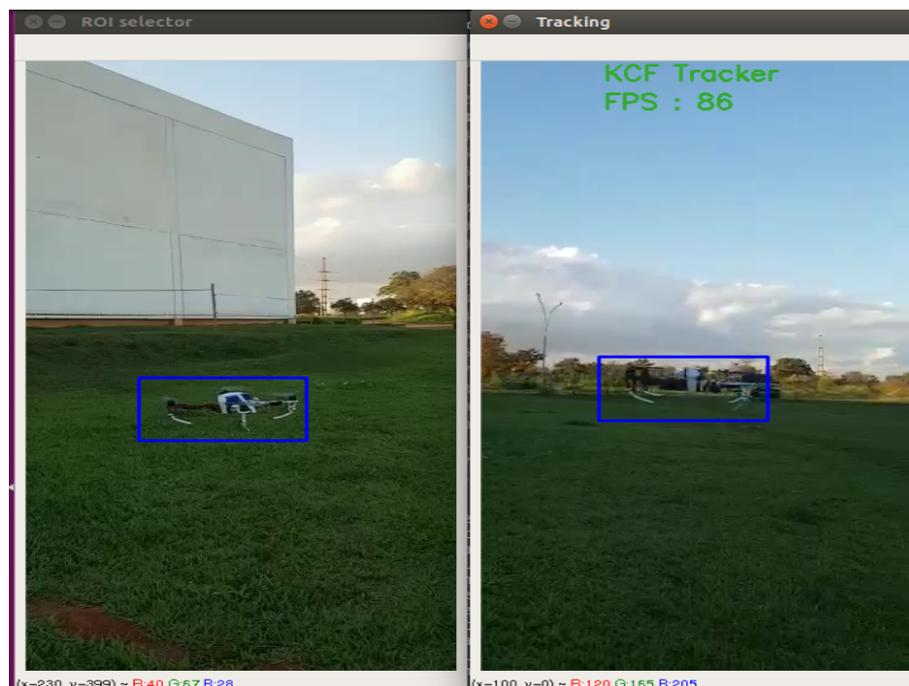
Figura 25 – Resultado obtido aplicando o KCF, com um vídeo pré-gravado.
