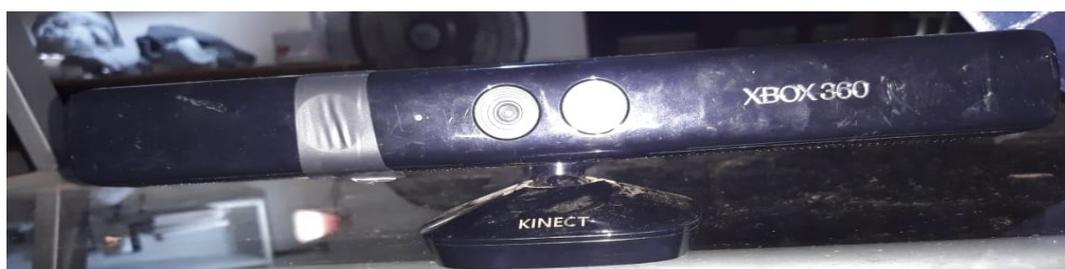
Figura 30 – Imagem do sensor *kinect* com o projetor infravermelho coberto para não haver interferência no receptor infravermelho.
