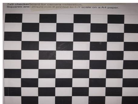
Figura 28 – Tabuleiro de xadrez 7X9 impresso em uma folha A4, com área dos quadrados de  $4cm^2$ , utilizado para calibração da câmera.
