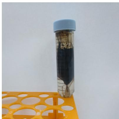
**Figura 4:** Foto da amostra PLWCO1 sob o processo de compressão osmótica.
