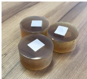
Figura 4.1. Pequenos Cubos de Alumínio Embutidos em Resina
