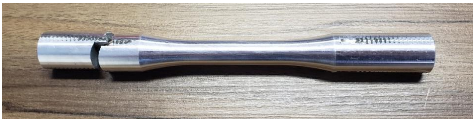
Figura 5.10. Corpo de Prova com Fratura fora do Comprimento útil
