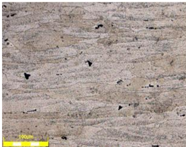
Figura 5.3. Micrografia da liga de Alumínio 7075-T651, na direção S, com aumento de 200x
