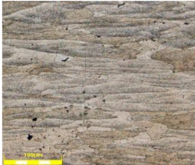
Figura 5.4. Micrografia da liga de Alumínio 7075-T651, na direção T, com aumento de 200x
