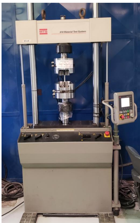
Figura 4.4. Máquina servo-hidráulica MTS 810
