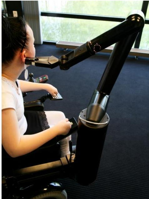
Figura 9 – Usuário do Manus Arm, com o controle original por joystick (Exact Dynamics, 2018).
