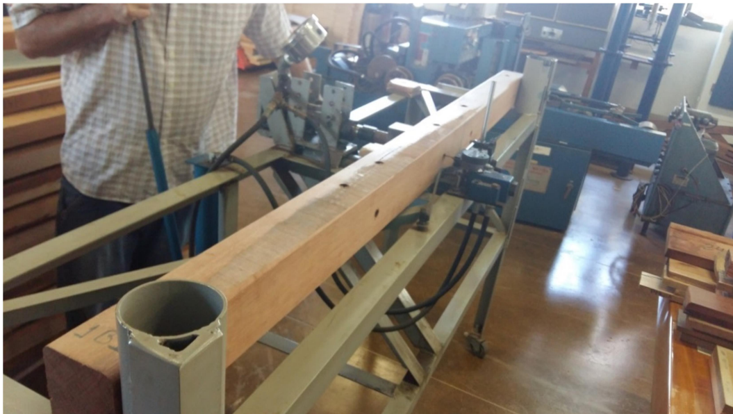
Figura 20. Máquina de classificação mecânica desenvolvido no Laboratório de Produtos Florestais (LPF). Fonte: Autor.
