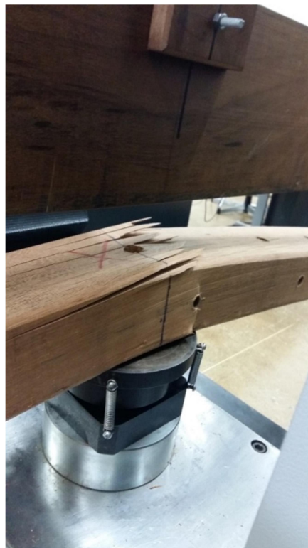
Figura 25. Rompimento da cruzeta durante o teste da norma NBR 8458/2010. Fonte: Autor.
