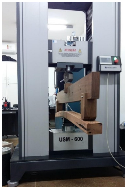
Figura 18. Cruzeta de Inhaíba ensaiada segundo a norma NBR 8458/2010. Fonte: Autor.
