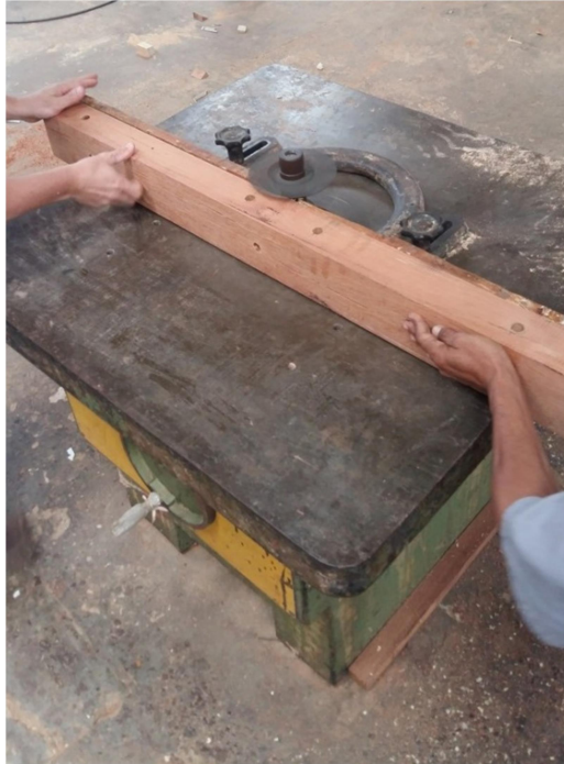
Figura 15. Confeção dos biseis das cruzetas com o uso da tupia. Fonte: Autor.
