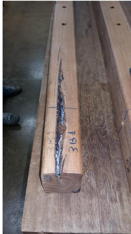
Figura 23. Ilustração da presença de canais traumáticos. Fonte: Autor.
