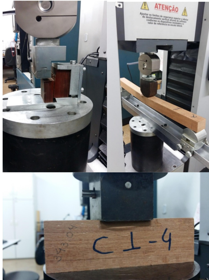
Figura 11. Ensaio mecânicos de cisalhamento verde, flexão estática e compressão perpendicular seco. Fonte: Autor.
