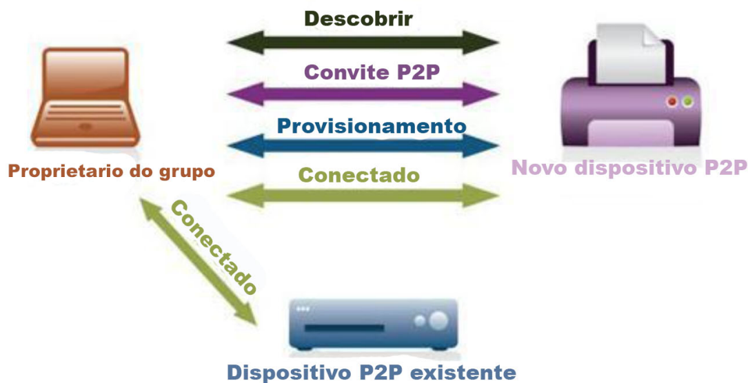
Figura 2.2: Adicionando um dispositivo a rede Wi-Fi Direct por procedimento de convite [37].
