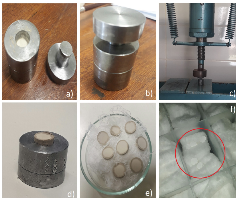
Figura 5 – a) Material da zircônia depositado no molde; b) Molde fechado pronto para compactação; c) Molde prensado na prensa hidráulica a 1 tonelada; d) Eletrólito compactado no molde; e) Eletrólitos de zircônia antes de ser levado ao forno; f) Eletrólitos de zircônia após a prensagem.
