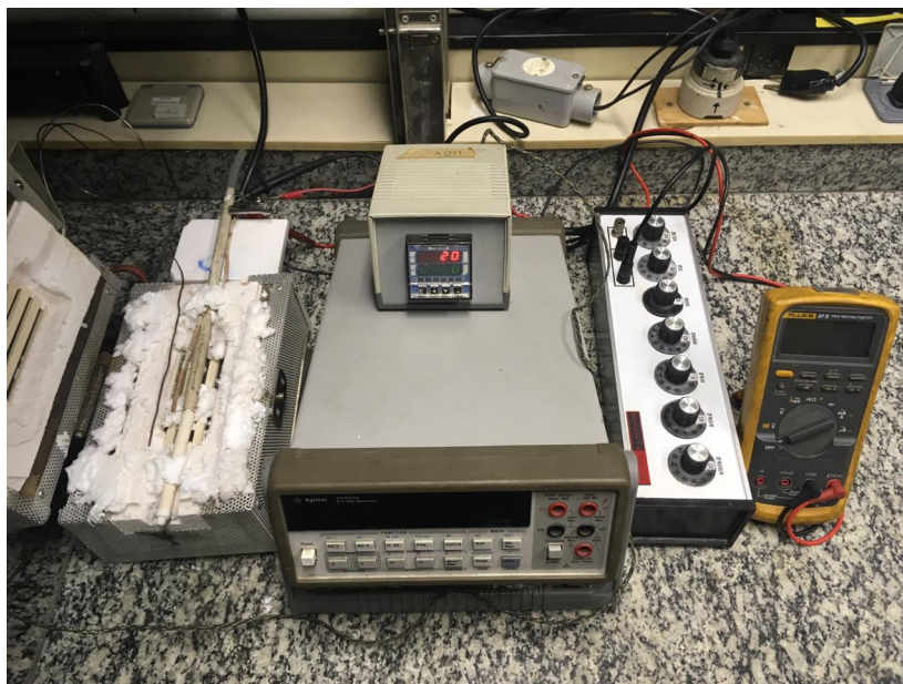
Figura 15 – Estrutura montada para o Teste de Hidrogênio.
