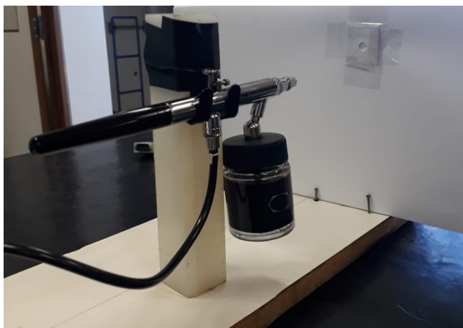
Figura 6 – Estrutura para deposição do slurry com aerógrafo nos eletrólitos.
