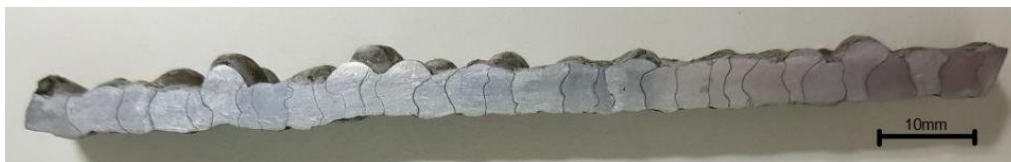
Figura 3.4 - Foto da macrografia de uma amostra de aço inoxidável 410 construído de cordões de solda
