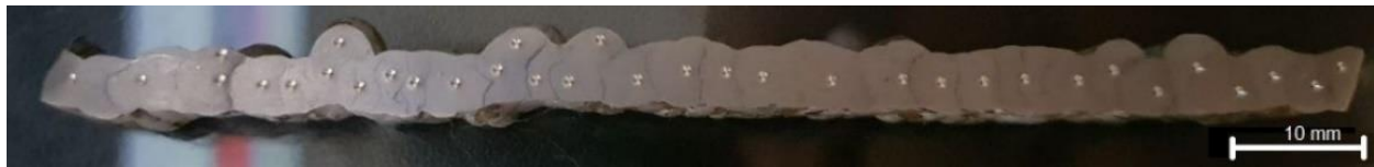
Figura 4.6 - Foto dos pontos em que foram medidas as durezas em um aço 410 NiMo
