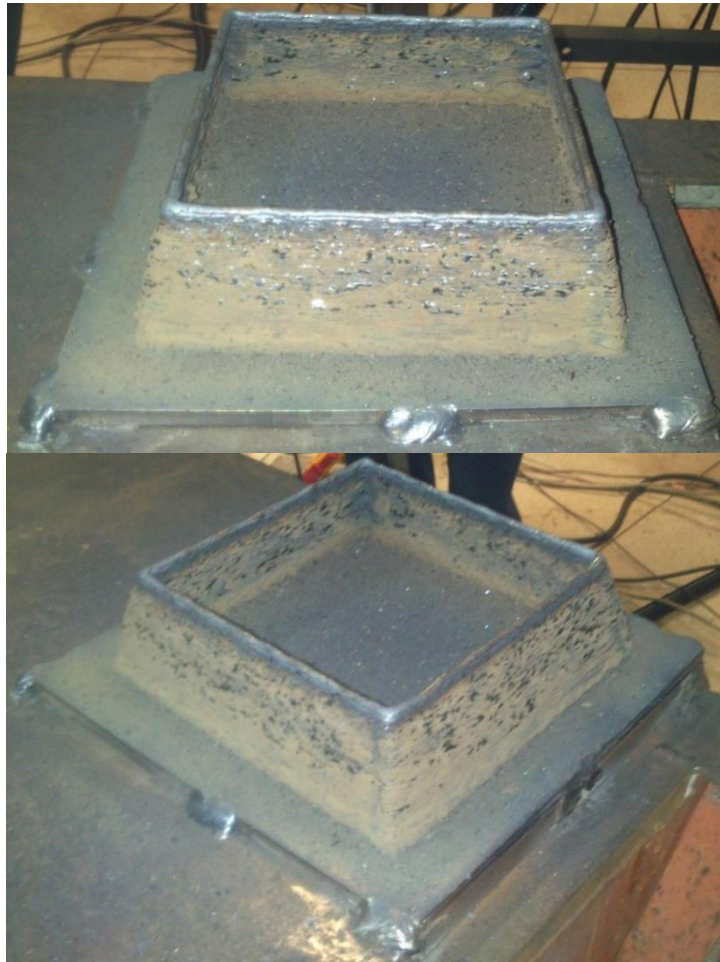
Figura 4.1 - Foto da construção do corpo da peça feita de cordões de solda de aço 410 NiMo
