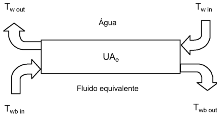
Figura 4.4 - Esquema equivalente da torre de resfriamento.
