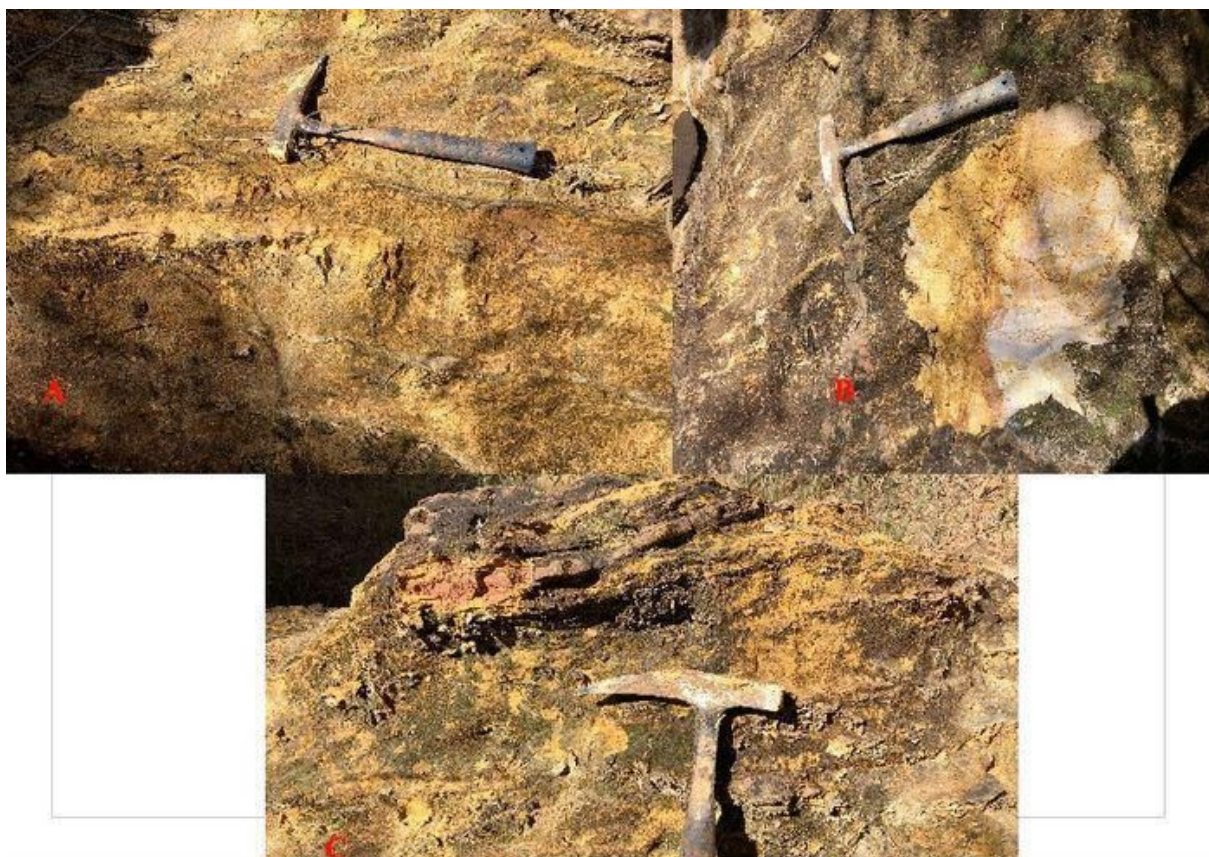
Figura 13 - Diferentes materiais de origem. Em sentido horário: A - observam-se veios de rocha mais resiliente paralelos ao martelo; B - contraste de cores entre os materiais; C- contraste da estrutura das camadas.
