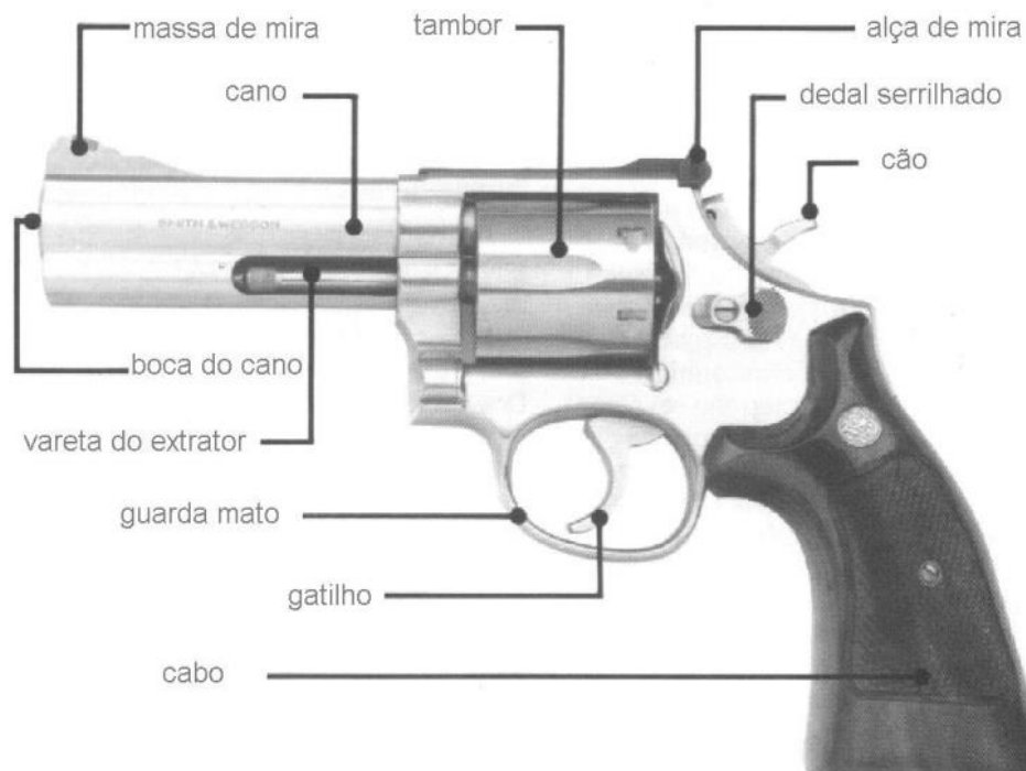
Figura 3 – Indicação dos principais componentes externos de uma arma de fogo. Fonte: Cartilha de armamento e tiro da SAT (2017)
