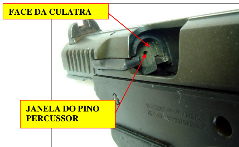
Figura 32 – Fotografia identificando a face da culatra e janela do pino percussor em uma pistola. Fonte: Santos (2015)
