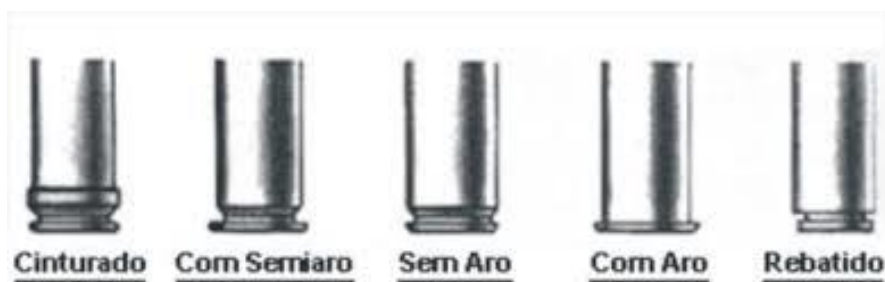
Figura 19 – Gravuras das cinturas dos estojos. Fonte: Zanotta (1992)
