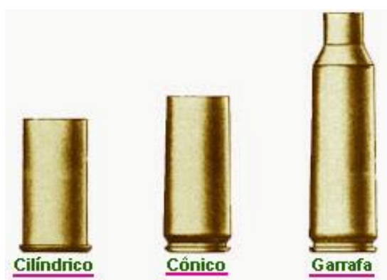
Figura 18 – Ilustração das geometrias dos estojos. Fonte: Instituto Defesa (2013)
