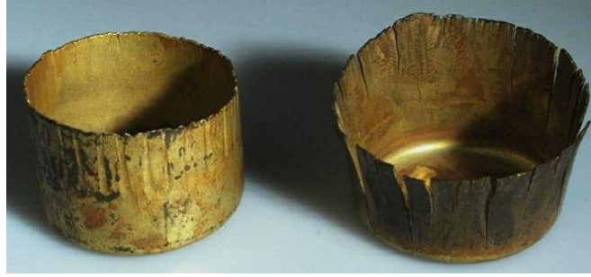
Figura 38 – Corrosão e quebra causada em antigo cartucho de latão pela presença da amônia. Fonte: Luca (1999)
