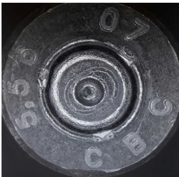
Figura 57 – Resultado final da digitalização da base do estojo. Fonte: autor
