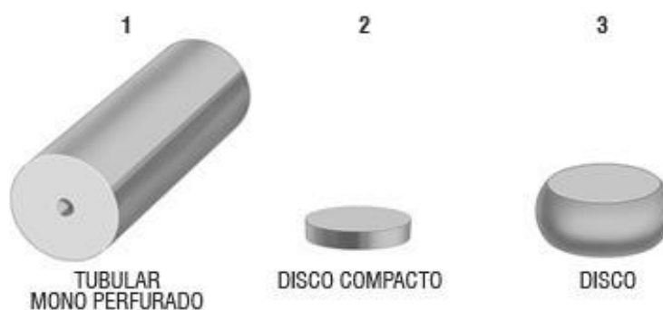
Figura 22 – Tipos de geometria tridimensional da pólvora. Fonte: Mundo das armas (2017)
