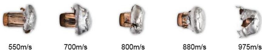
Figura 15 – Expansão do projétil de acordo com a velocidade do mesmo. Fonte: Gupta, (2014)
