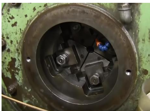
Figura 13 – Máquina de forja fria circular utilizada no processo. Fonte: Rifling (2015)
