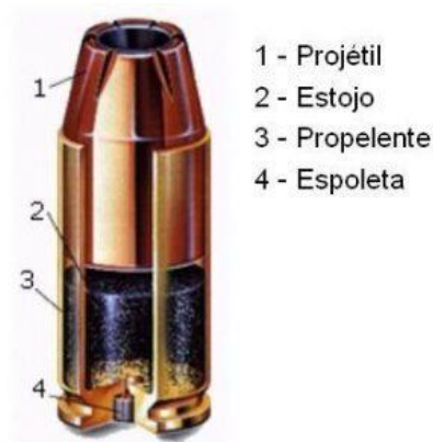
Figura 14 – Esquema dos componentes da munição. Fonte: Alves (2012)
