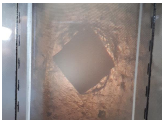
Figura 66 – Losango causado pelo penetrador no material. Fonte: autor
