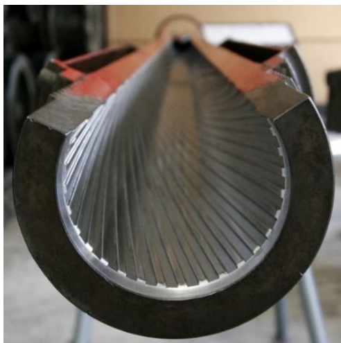
Figura 10 – Destaque das raias do canhão do carro de combate Royal Ordnance L7. Fonte: Baku (2005)
