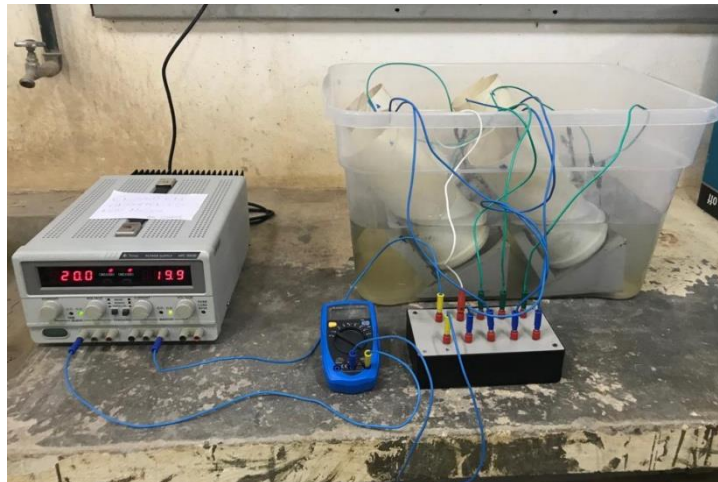
Figura 3- 9: Ensaio de Migração de íons cloreto em andamento.
