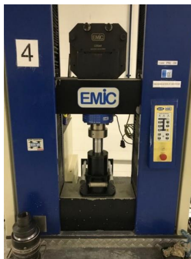
Figura 3- 6: Prensa utilizada para a realização do ensaio de Módulo de Elasticidade.
