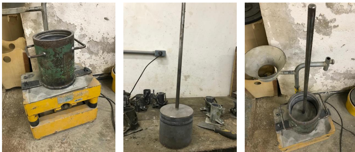
(a) cilindro e mesa vibratória
