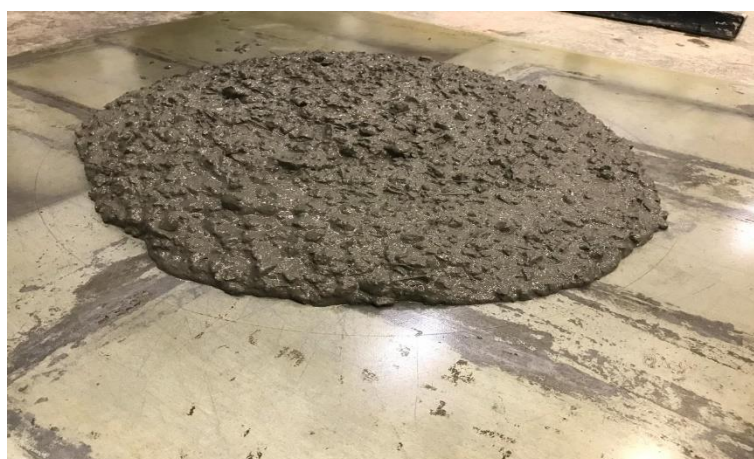
(b) espalhamento do concreto
