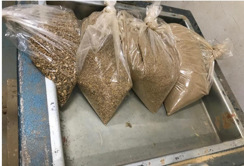
(a) Separação do material em classes de grãos
