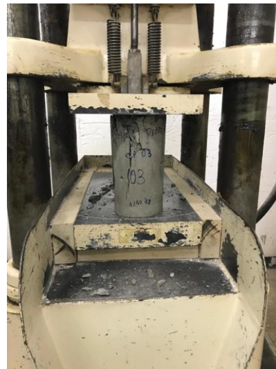
(d) ensaio de compressão
