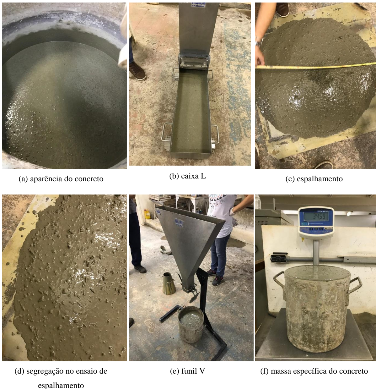
Figura 51 – Concretagem do primeiro traço e ensaios no estado fresco
