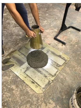
(c) ensaio de espalhamento
