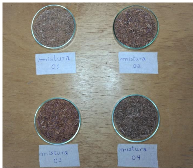
Figura 4 – Misturas de resíduos de espécies amazônicas para ensaios de peletização
