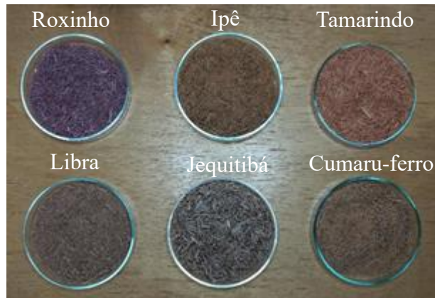
Figura 3 – Madeiras selecionadas para estudo após trituração em moinho de martelos.
