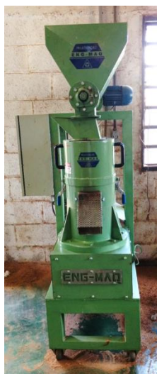
Figura 5 – Peletizadora laboratorial utilizada na produção dos pellets .
