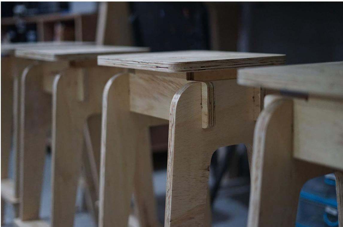
Figura 11 - Banquetas fabricadas com Roteadora CNC
