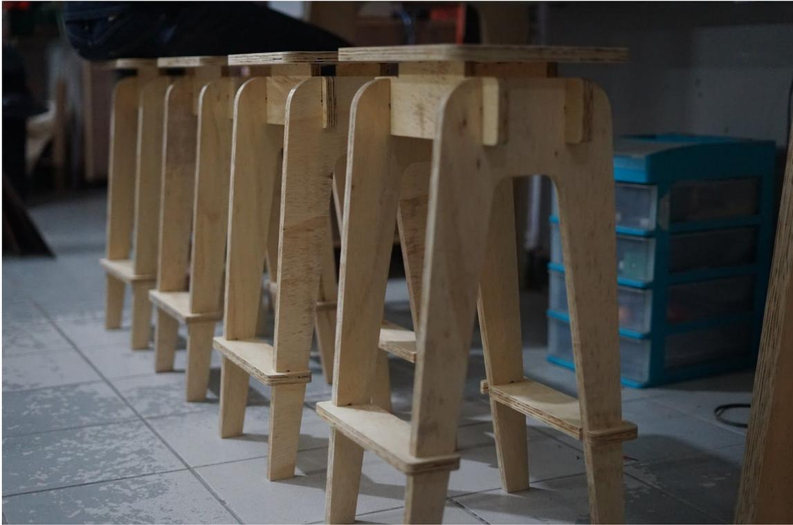
Figura 10 - Banquetas fabricadas com Roteadora CNC
