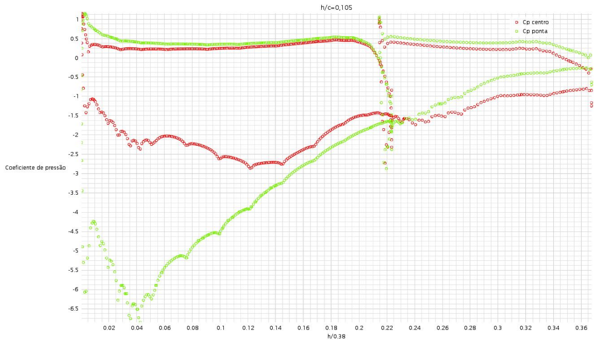
Figura 4.22: Coeficiente de pressão gerado por simulações no centro e na ponta para h/c = 0,105 .
