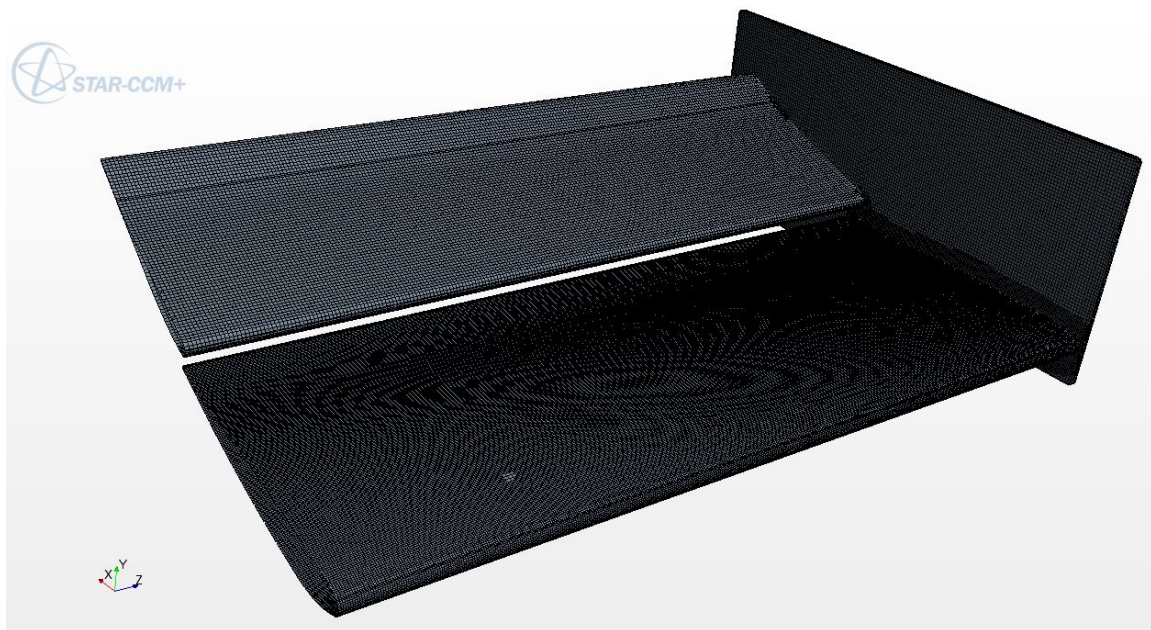
Figura 3.5: Discretização da asa.
