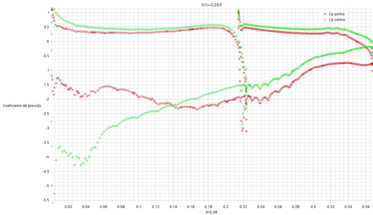
Figura 4.20: Coeficiente de pressão gerado por simulações no centro e na ponta para h/c = 0,263 .
