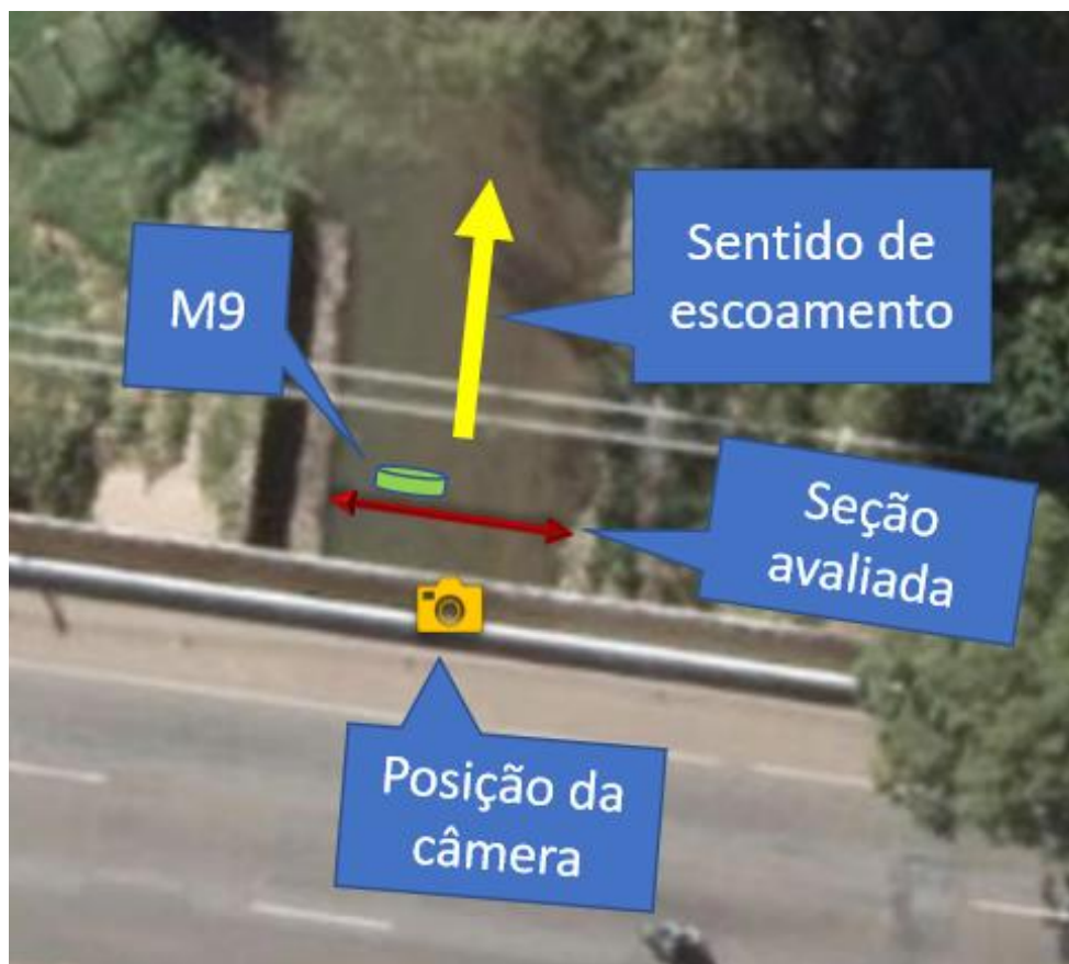
Figura 6.29 - Posicionamento dos equipamentos para medição
