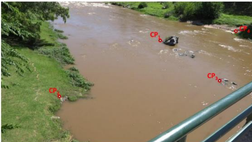
Figura 5.2 - Exemplo de marcação de pontos de controle. FONTE: my.usgs.gov
