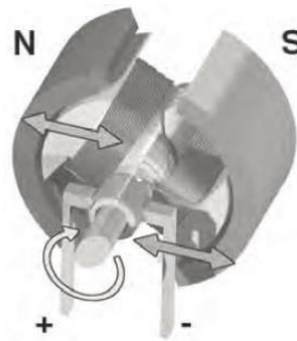
Figura 2.10 Estrutura básica de motor de corrente contínua (Barrientos, et al, 2007)
