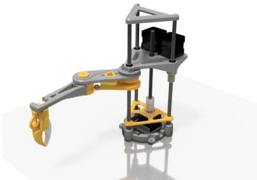
Figura 5.1 Manipulador SCARA fabricado em manufatura aditiva (JJROBOTS, 2018)
