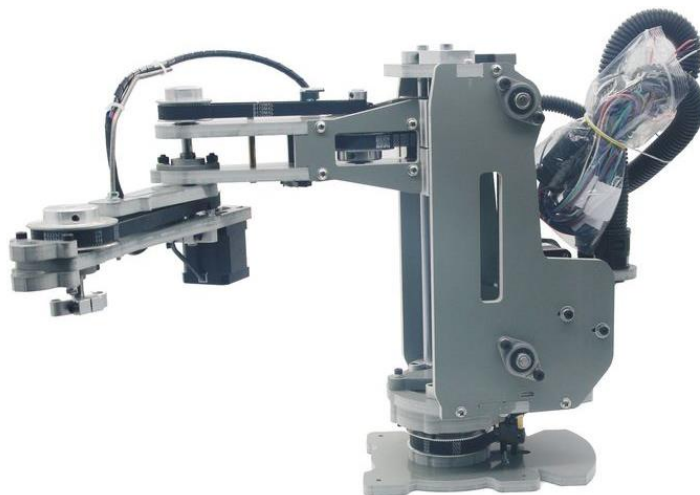
Figura 5.2 Manipulador fabricado por usinagem de placas (TZT, 2018)
