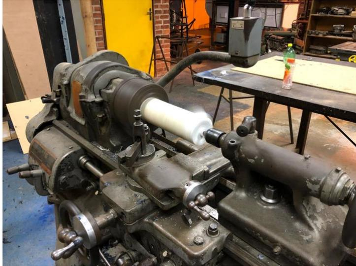
Figura 5-3 - Parafina durante o processo de centrifugação.
