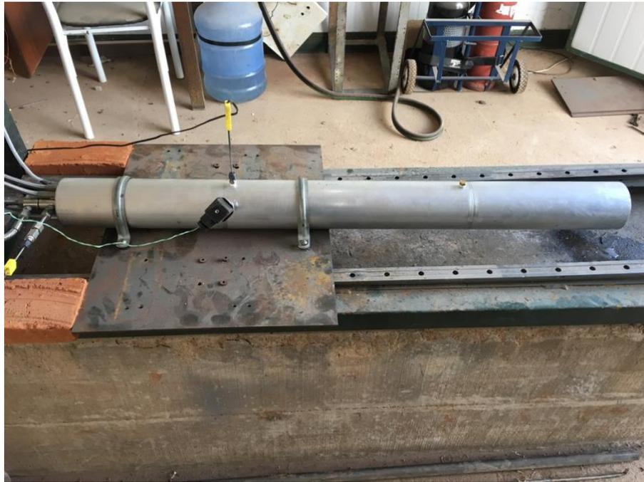
*Figura 6-7 Posicionamento e Fixação do Motor na Bancada*
