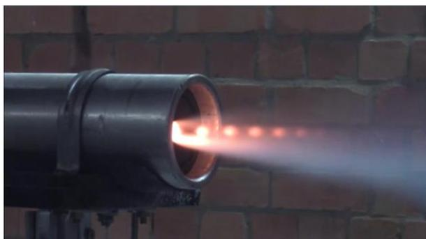
Figura 6-1 - Durante a realização do ensaio - evidência das ondas de choque com vaporização da parafina.
