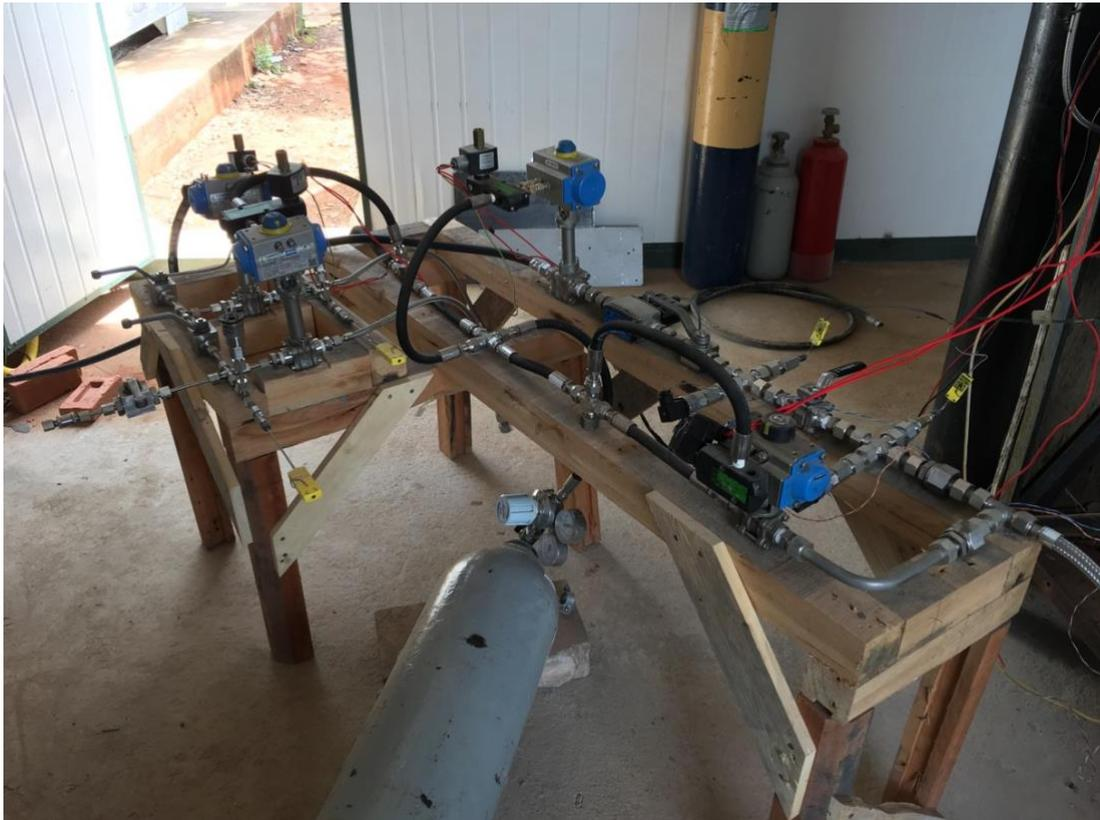
*Figura 6-6 Sistema de Tubulação da Bancada com Válvulas e Sensores*
