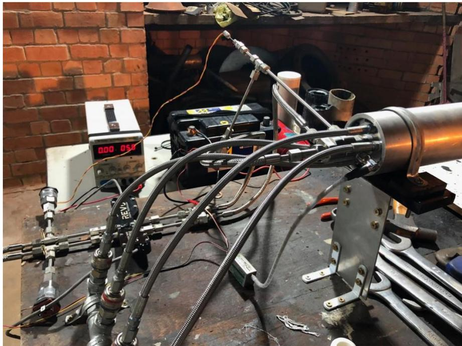
Figura 4-3 - Sistema de ignição e tampa injetora do motor.
