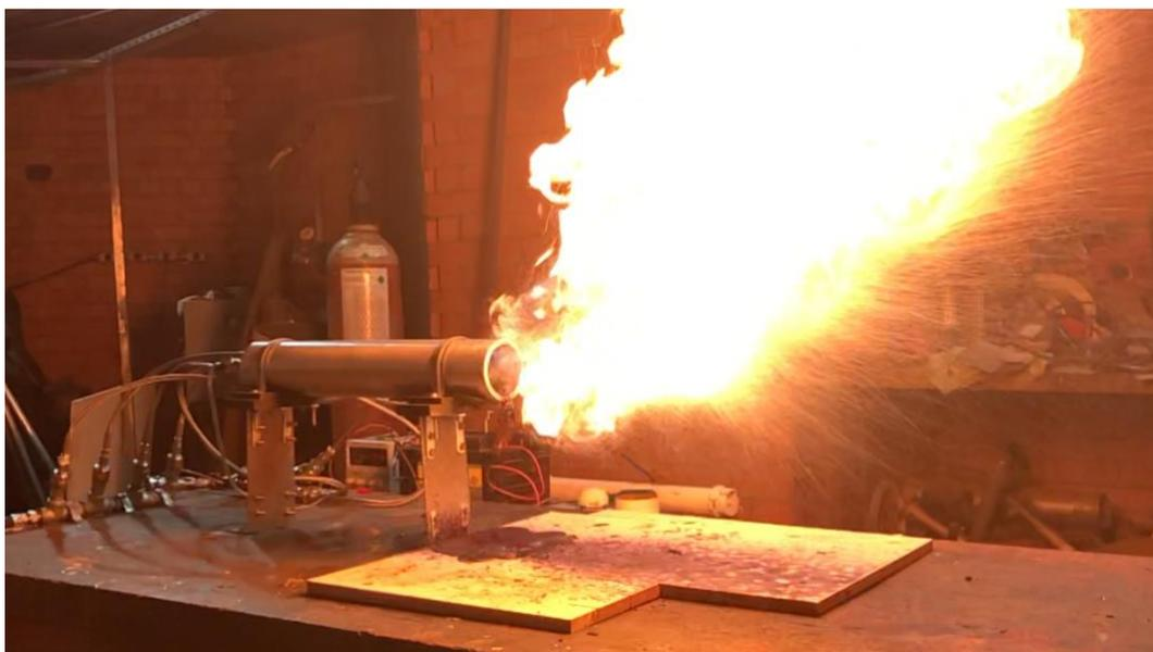
Figura 5-6 - Testes preliminares da bancada para os quais não houve pressurização da câmara.
