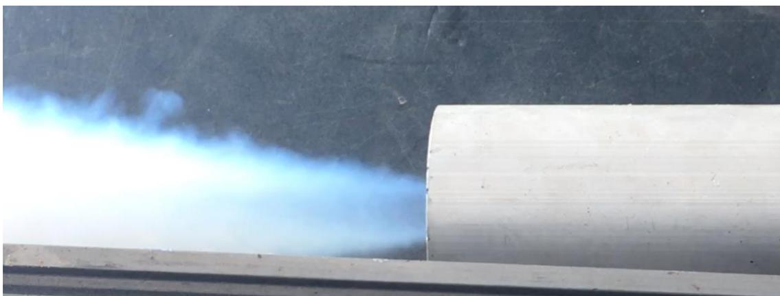
*Figura 6-15 Imagem da Exaustão Teste 1 - Sem Entupimento Sônico e Grande Vaporização de Parafina*
