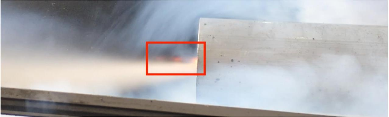
*Figura 6-26 Teste 3 - Evidência de Jato e Vaporização da Parafina*
