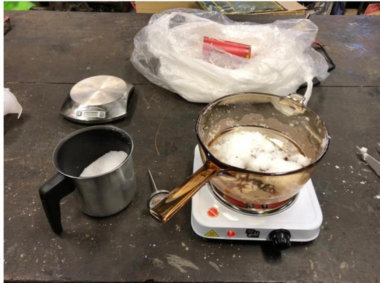
Figura 5-1 - Procedimento de aquecimento da parafina no forno elétrico.
