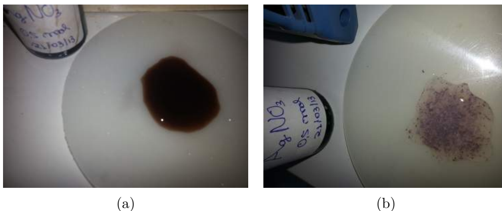
Figura 10 – Teste com nitrato de prata (a) amostra com alta concentração de cloro (b) amostra com menor concentração de cloro. Fonte: Própria (2015).
