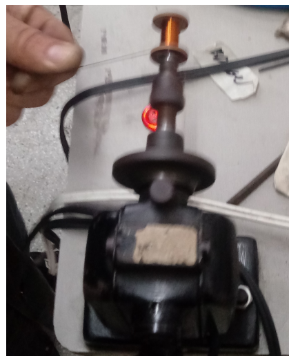
Figura 22. Embobinamento do núcleo
