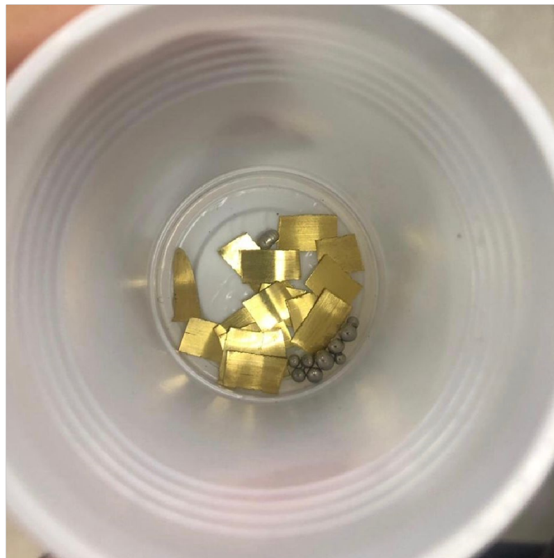
Figura 29: Materiais para fazer uma liga de ouro branco. Fonte: autora.
