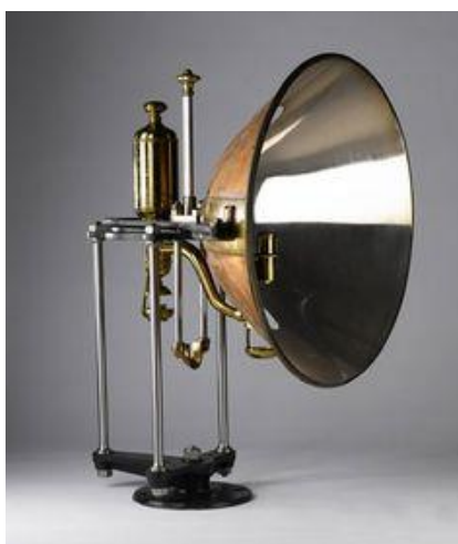
Figura 21 Refletor parabólico projetado por Robert Stevenson-1810
