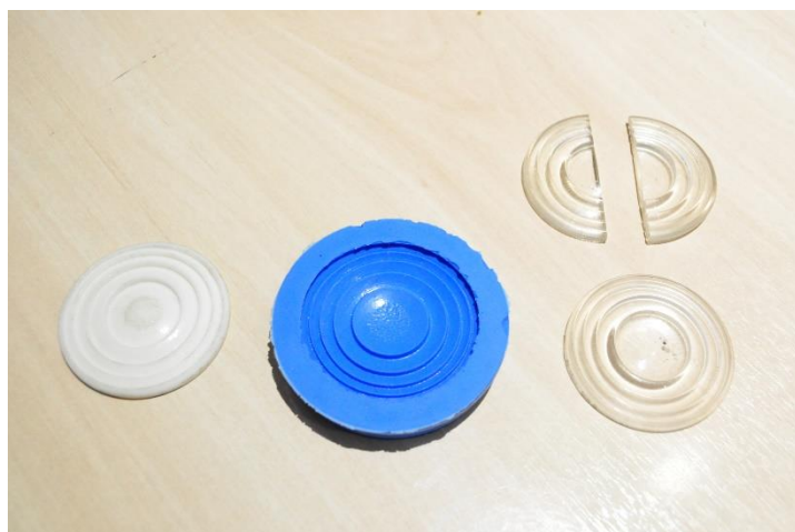
Figura 32 Impresso 3D, molde de silicone e peça em resina – o autor
