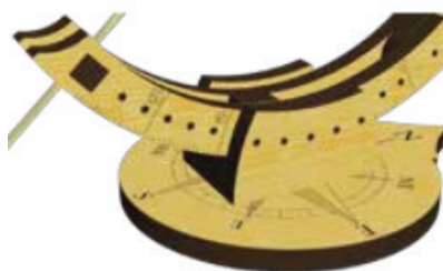
Figura 46. Mecanismo de ajuste de latitude em detalhe.
