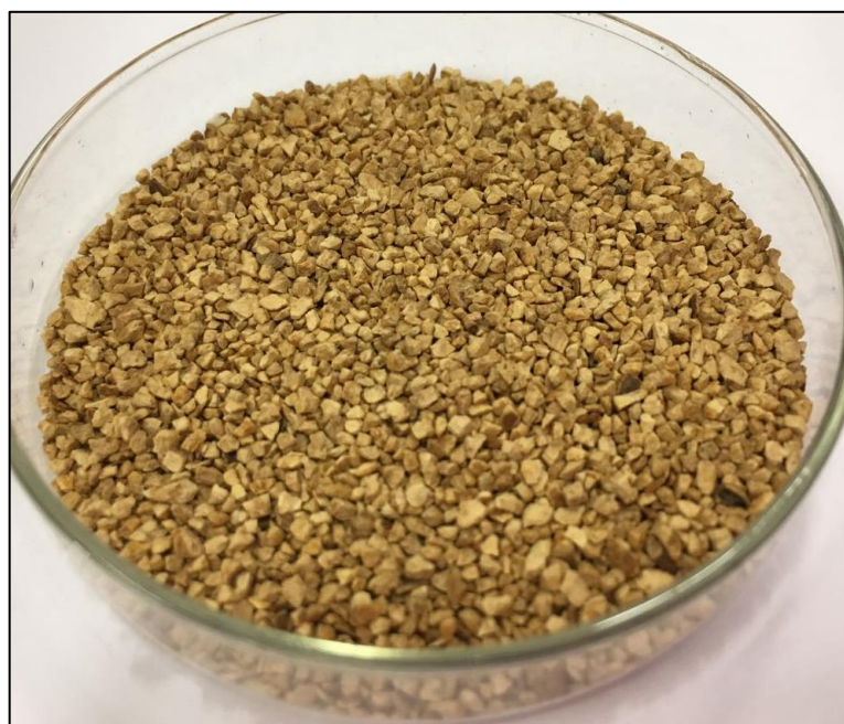
Figura 10 – Casca de tingui triturado e moído com granulometria entre 16 e 18 mesh.
