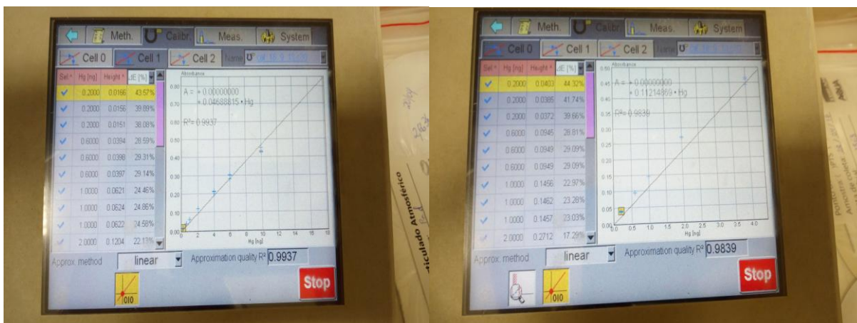
Figura 12 - Curvas analíticas para as duas células do DMA-80, no monitor de acompanhamento do equipamento.
