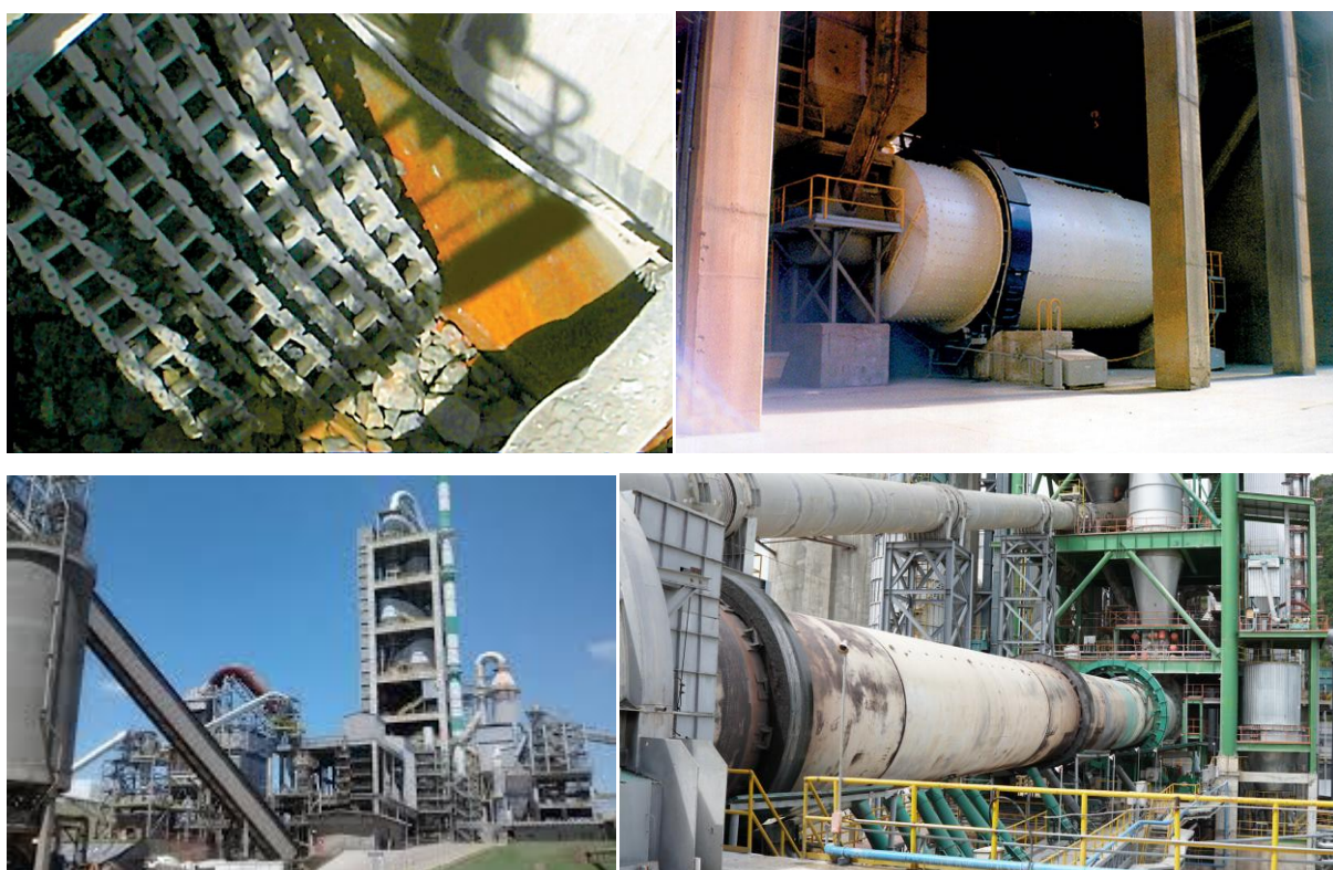
Figura 4 - Equipamentos usados na produção de cimento, respectivamente, britador, moinho, pré aquecedor e forno rotativo. (Fontes: SNIC, Ferrari et al e MS Ambiental)
