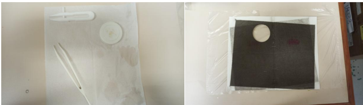
Figura 10 - Análise dos filtros de MP. Pinças e molde de Teflon à esquerda. Filtro aberto com corte de fração retirada para determinação de mercúrio à direita.
