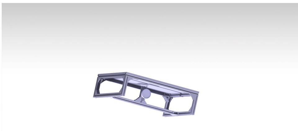
Figura 52 – Modelo de bancada para teste de deflexão em placa fina, visão inferior.
