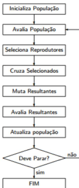
Figura 15 – Estrutura básica do algoritmo genético. Fonte: (ÁLVARES, 2012).
