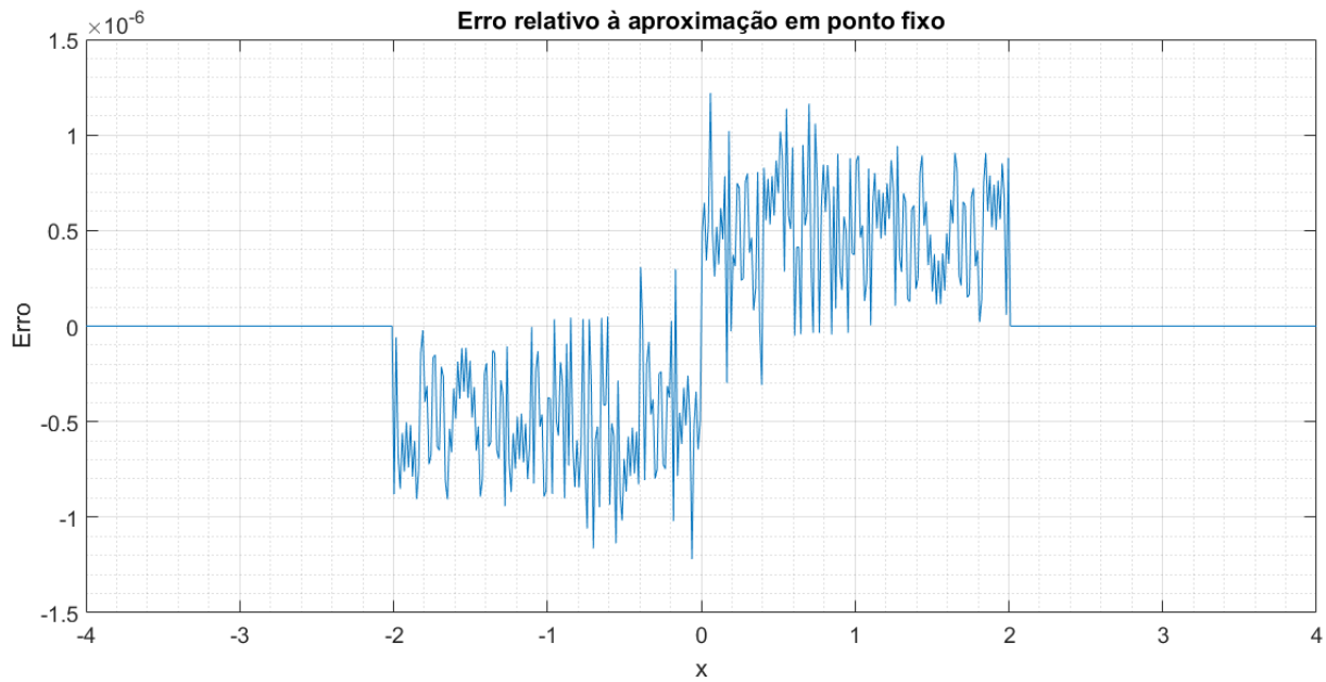
Figura 4.4: Erro relativo à representação por ponto fixo para a aproximação parabólica da função tangente hiperbólica
