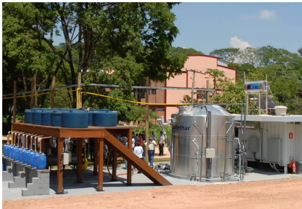
Figura 3.6 - Reator anaeróbico. Fonte: Methanum (2015)
