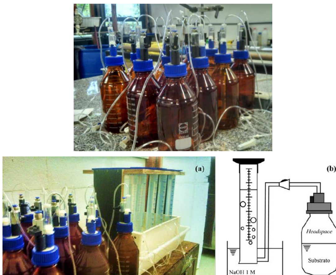
Figura 3.9 Reatores de bancada e sistema de medição. (FONTE: Vieira, 2017)
