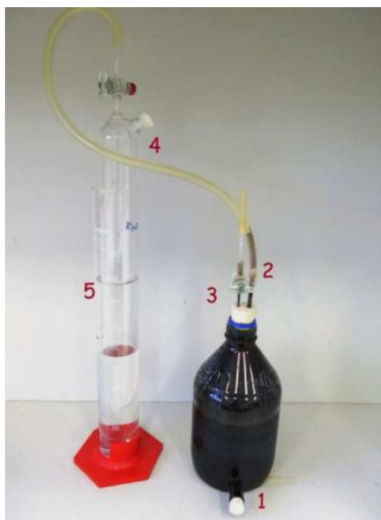
Figura 3.8 Reator anaeróbico de bancada e sistema de medição de biogás (1) saída para retirada de material digerido; (2) saída de biogás do reator para a ampola; (3) saída para retirada de amostra de biogás; (4) ampola de vidro parcialmente imersa em proveta com água; (5) deslocamento da coluna de água indicando o volume de biogás gerado. (FONTE: Pavi, 2016)
