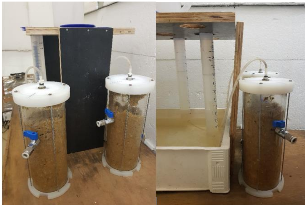
Figura 4.5 – Reatores de bancada para digestão anaeróbia
