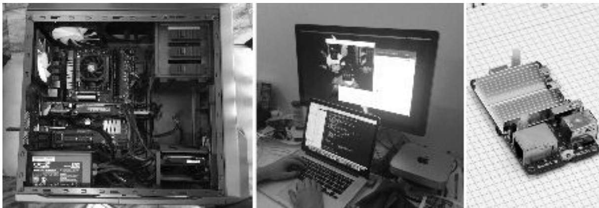
Figura 29: Os 3 computadores utilizados no projeto, da esquerda para a direita: 1. computador de gabinete: processador AMD, 12GB de RAM, placa gráfica NVIDIA Geforce GTX 970 4GB Windforce; 2. MacBook Pro Retina 2013: processador intel i7, 16GB de RAM, placa gráfica NVIDIA GeForce GT 750M 2GB; 3. ODROID-U3: processador ARMv7 de 1.7GHz quad-core (armhf) e 2GB de RAM.
