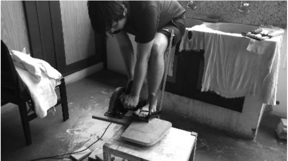
Figura 26: Realizando os cortes na régua de deck com uma serra circular.
