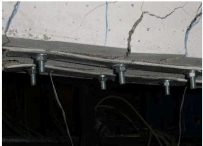
a) Seção de viga reforçada com MF-EBR b) Ensaio de viga reforçada com MF-EBR
