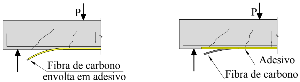
Figura 2.29: Ruptura dada pelo descolamento do PRF (DE)
