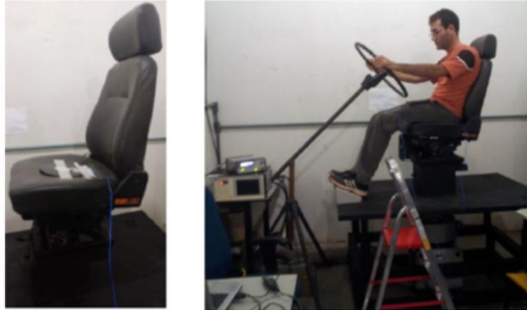
Figura 7 – Posicionamento do sensor no assento e bancada completa com participante. (Moore (2017))
