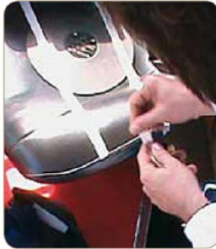
Figura 8 – Sensor HVM 100 no *Seat Pad* e sua fixação no assento do condutor. (Lopes (2012))
