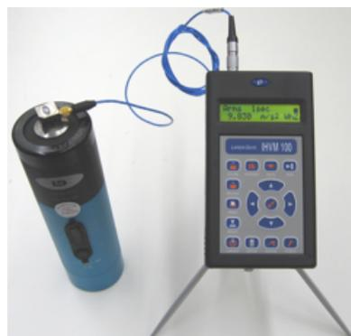
Figura 34 – - Exemplo de calibração de acelerômetro, na foto estão presente HVM 100 e Calibrador de acelerômetros (GROM, 2018)
