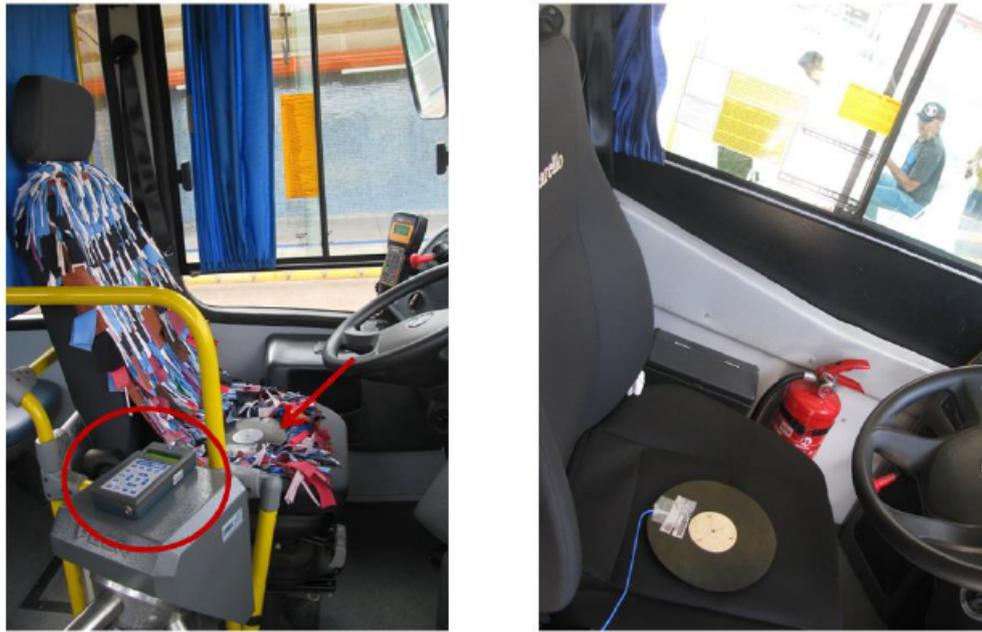
Figura 12 – Disposição dos equipamentos utilizados. (Silva e Nunes (2016))
