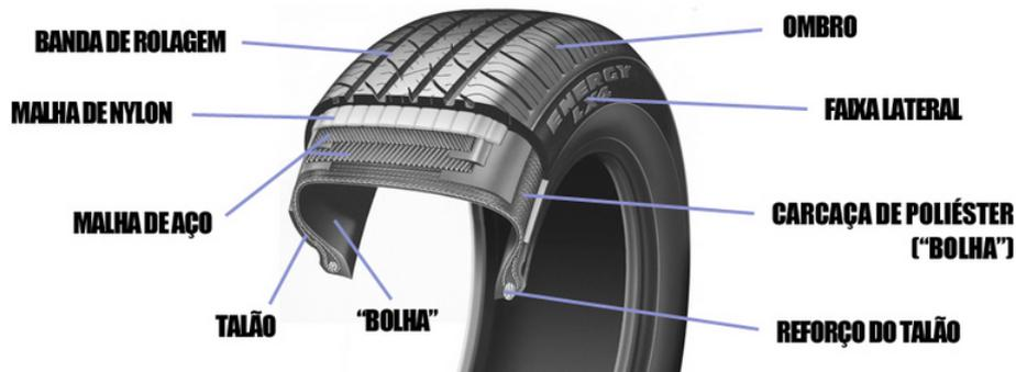
Figura 20 – Pneu e seus componentes.
