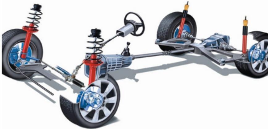
Figura 19 – Sistema de suspensão veicular.
